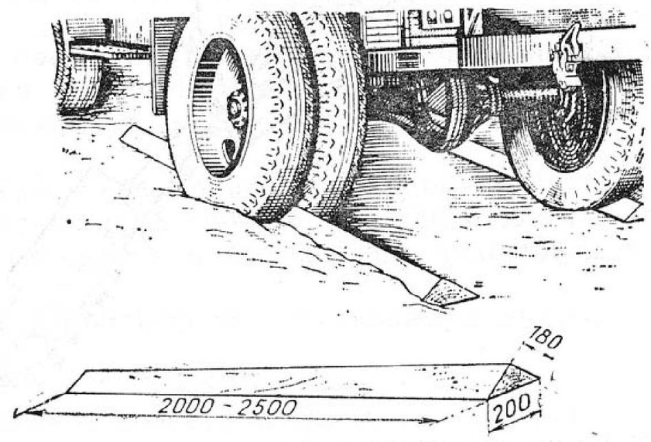
**Полуподъем** применяется при вытаскивании застрявших объектов с использованием специально оборудованных эвакуационных тягачей или стрелы-двуноги.
