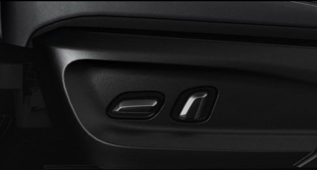
Сиденье водителя с 10-ю электрическими регулировками (в т.ч. поясничного упора), и сиденье переднего пассажира с 4-мя электрическими регулировками, обеспечивают удобную посадку и комфорт на передних сидениях.
