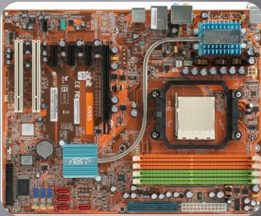
В ДАННОМ СЛУЧАЕ ЧИПСЕТ СНАБЖЕН СИСТЕМОЙ ОХЛАЖДЕНИЯ
