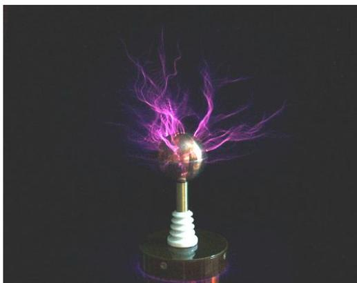
На заостренных участках проводников с напряжением в десятки и сотни кВ возникает огромная напряженность электрического поля – свыше миллиона вольт на метр, вследствие чего прилежащий воздух ионизируется и происходит стекание заряда в виде маленьких искр, образующих корону
