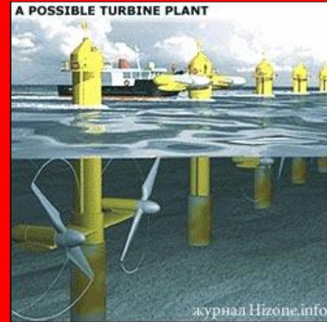
Турбина, использующая энергию приливов и отливов
