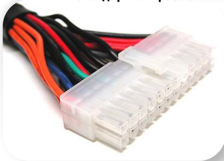
ATX с 24 контактами (Extended ATX)
