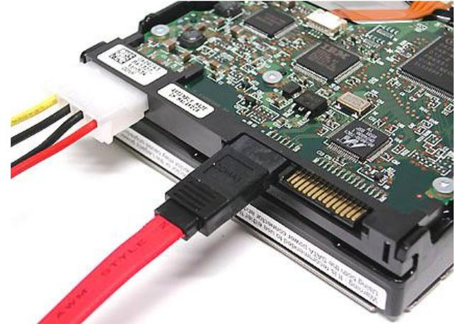
Питание SATA может обеспечиваться двумя способами
