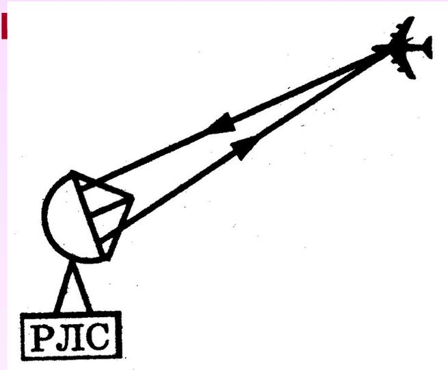
Радиопередатчик формирует импульсы, поступающие в антенну. Антенна формирует луч, узкий в горизонтальной плоскости и широкий – в вертикальной
