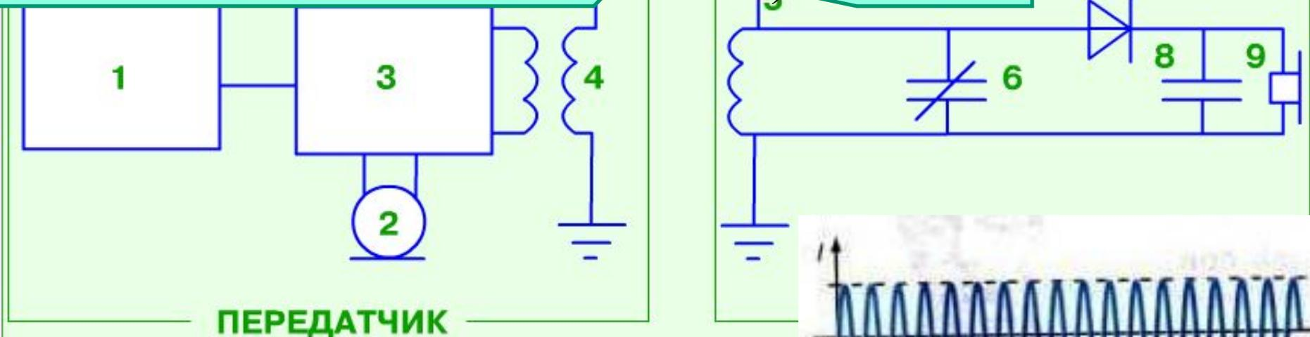
**1** — **генератор высокой частоты**, вырабатывает электрические колебания высокой частоты.
