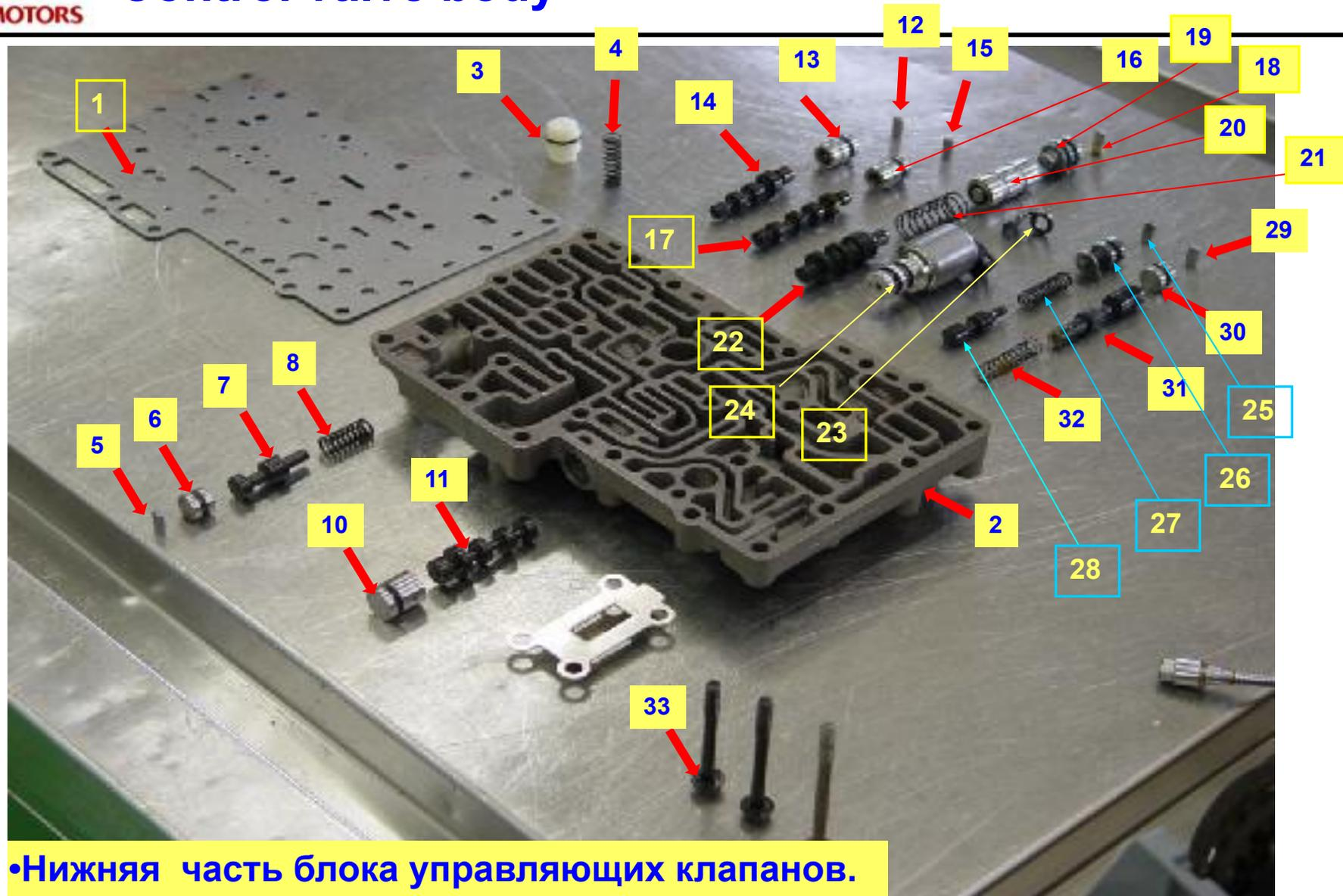
•Нижняя часть блока управляющих клапанов.
