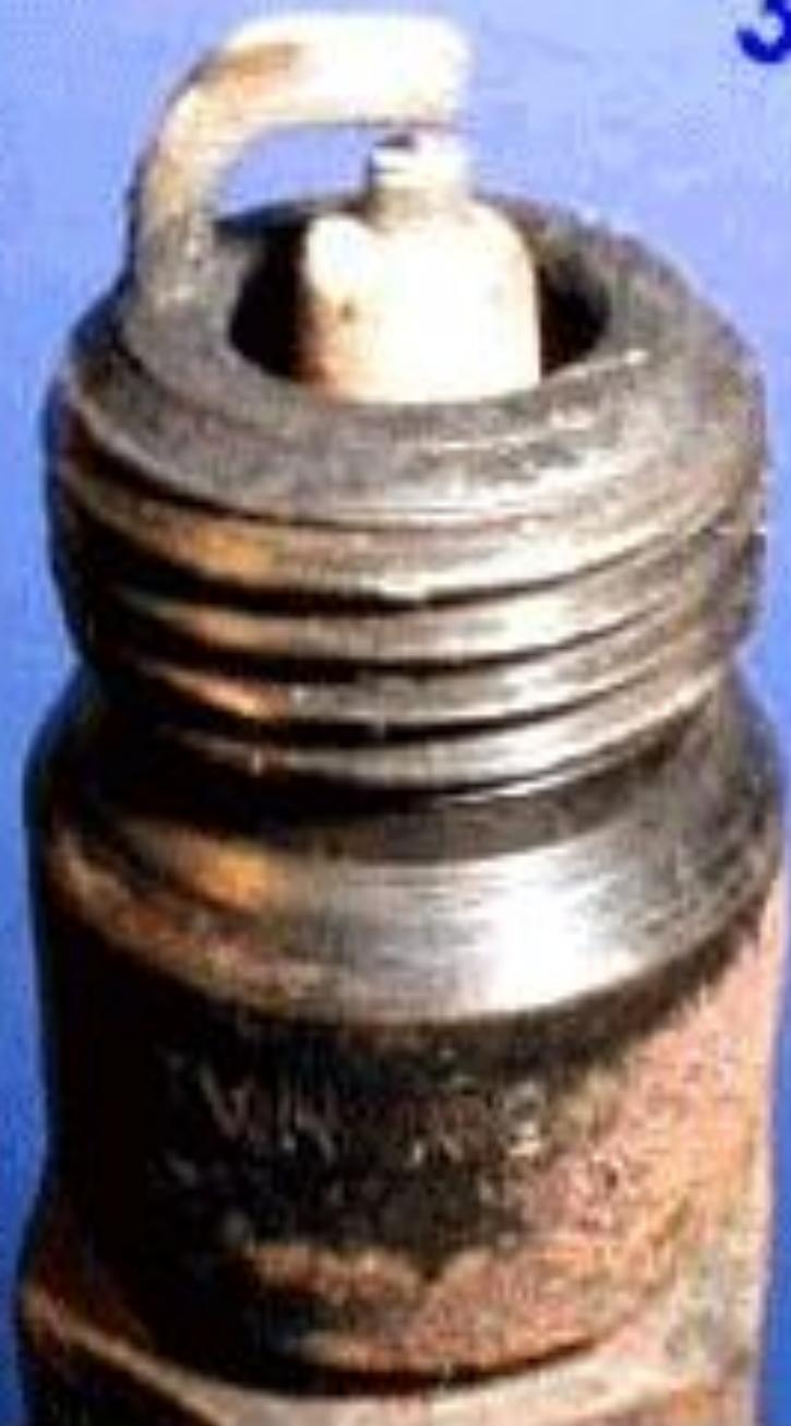
**Фото №3 - наоборот, пример чрезмерно бедной воздушно-топливной смеси. Цвет электрода от светло-серого до белого. Здесь есть повод для беспокойства. Езда на слишком обедненной смеси и при повышенных нагрузках может стать причиной значительного перегрева, как самой свечи, так и камеры сгорания, а перегрев камеры сгорания прямой путь к прогару выпускных клапанов.**
