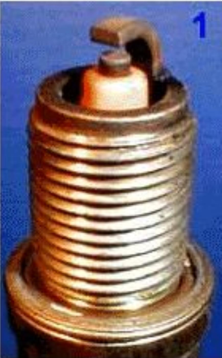
**На фото №1 изображена свеча, вывернутая из двигателя, работу которого можно считать отличной. Юбка центрального электрода имеет светло-коричневый цвет, нагар и отложения минимальны. Полное отсутствие следов масла. Владельцу данного мотора можно только позавидовать, и есть чему: это экономичный расход топлива и отсутствие необходимости доливать масло от замены до замены.**
