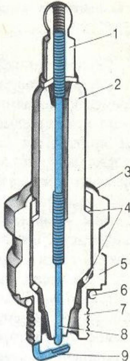
**СЛУЖИТ ДЛЯ ОБРАЗОВАНИЯ ИСКРОВОГО ЗАЗОРА В КАМЕРЕ СГОРАНИЯ, ГДЕ ПРОСКАКИВАЕТ ЭЛЕКТРИЧЕСКАЯ ИСКРА. НОРМАЛЬНЫЙ ЗАЗОР МЕЖДУ ЭЛЕКТРОДАМИ 0,7-0,9 мм**
