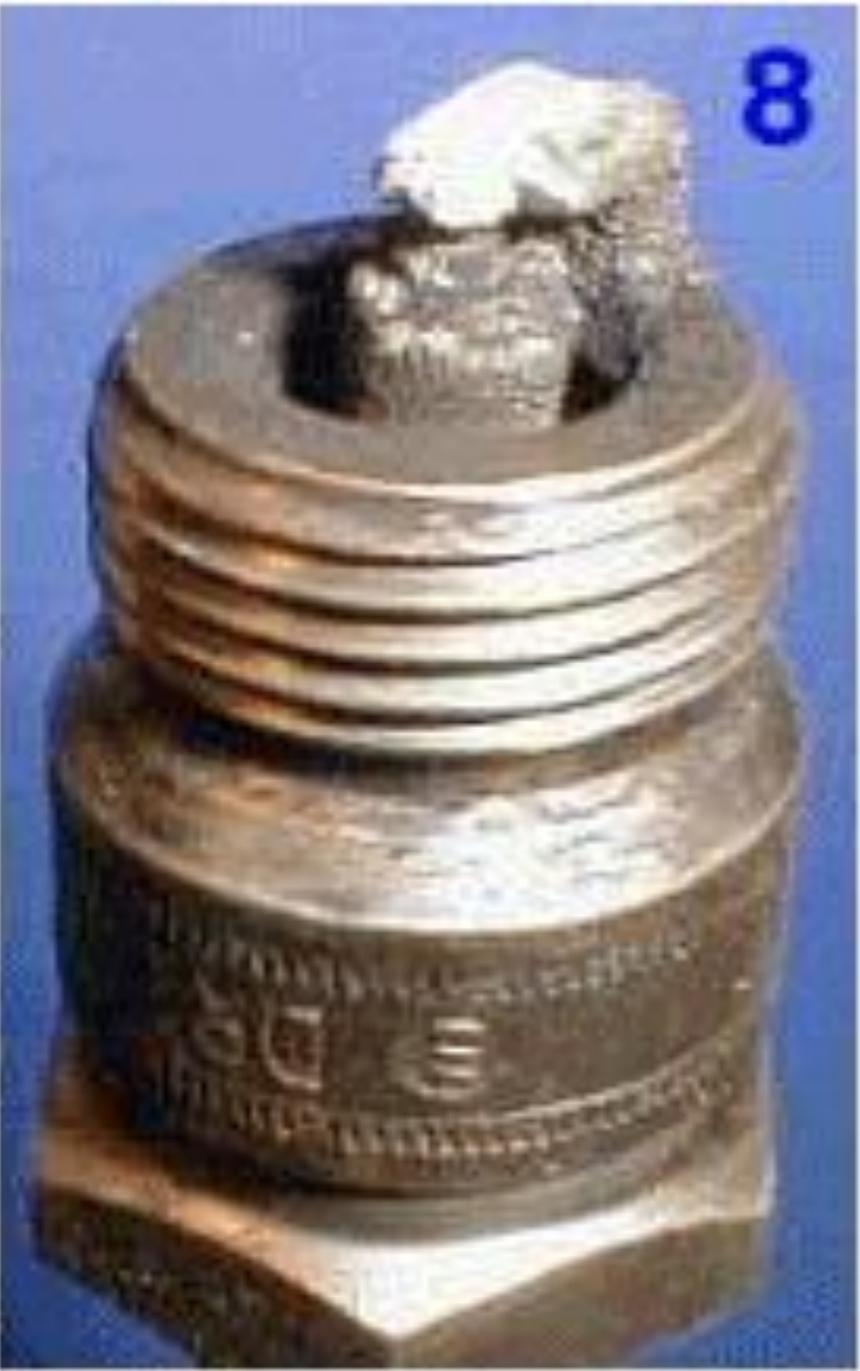
**Фото № 8 последнее в этом обзоре. Электрод свечи оброс зольными отложениями, цвет не играет решающей роли, он лишь свидетельствует о работе топливной системы. Причина этого нароста - сгорание масла вследствие выработки или залегания маслоъемных поршневых колец. У двигателя повышенный расход масла, при перегазовках из выхлопной трубы сильное синее дымление, запах выхлопа похож на мотоциклетный.**
