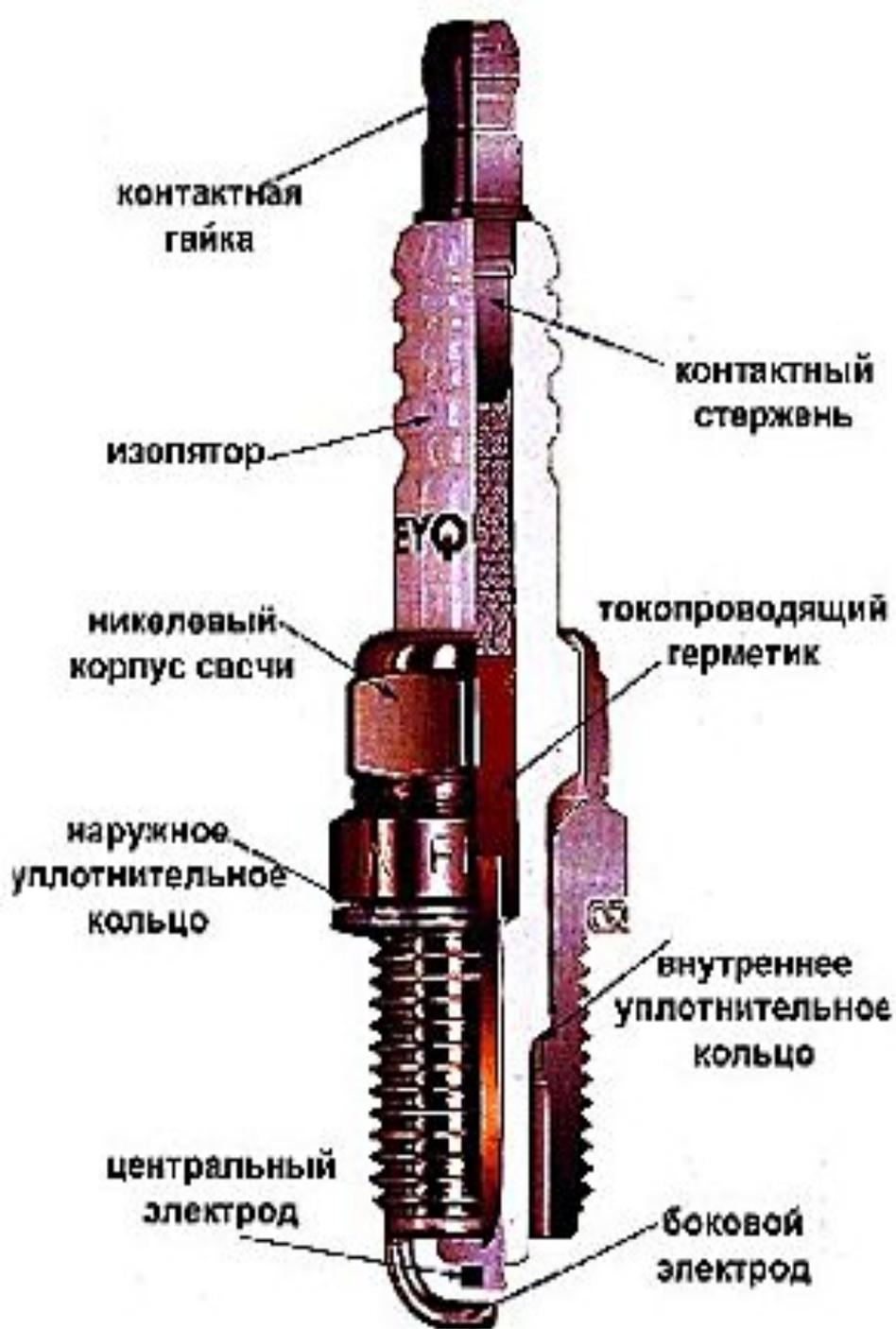
**Детали свечи, находящиеся в камере сгорания, подвергаются высоким термическим, механическим, электрическим нагрузкам, а также химическому воздействию продуктов неполного сгорания топлива. Температура в ней изменяется от 70 до 2500°С, давление газов достигает 50-60 бар, а напряжение на электродах доходит до 20 кВ и выше.**
