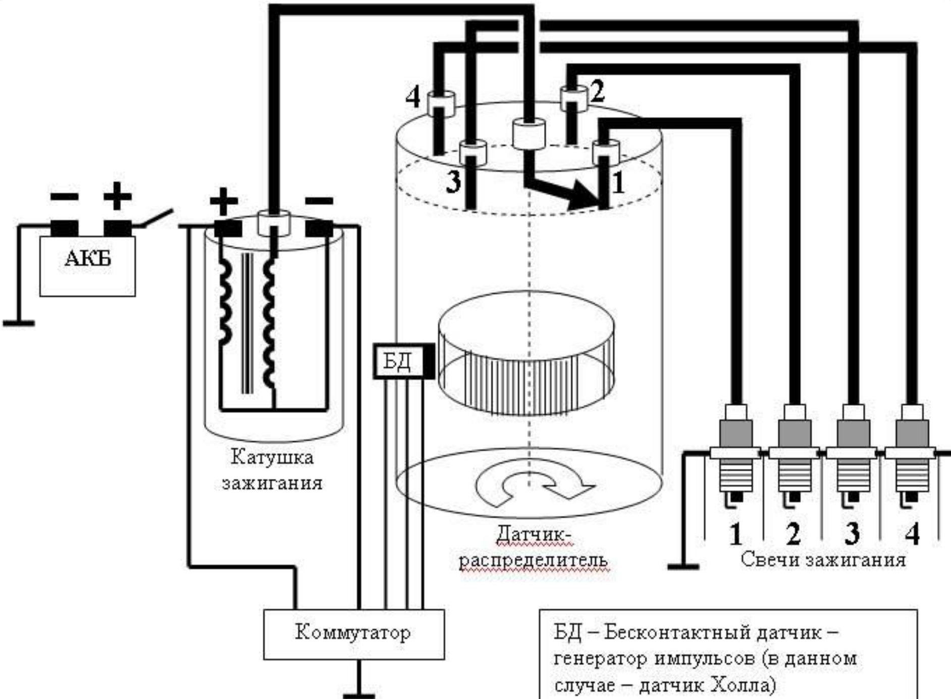
БД – Бесконтактный датчик – генератор импульсов (в данном случае – датчик Холла)
