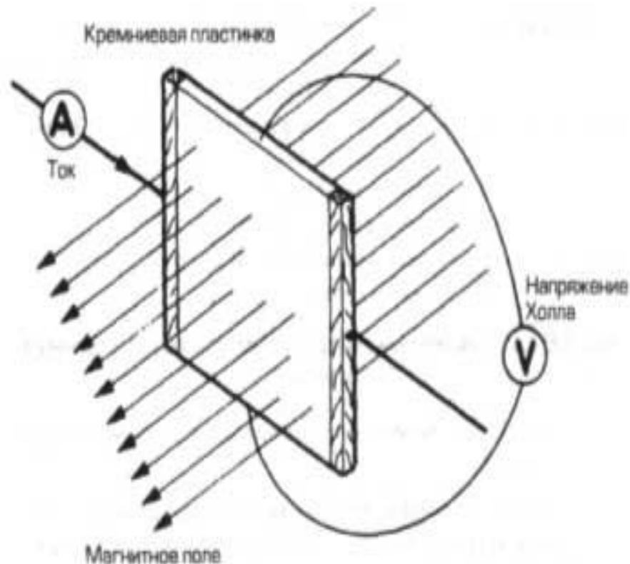
При открытом зазоре между постоянным магнитом и датчиком Холла пластинка выдает напряжение. Если зазор перекрывается лопастью обтюратора, магнитное поле замыкается через лопасть и не попадает на пластинку Холла. Напряжение при этом падает.
