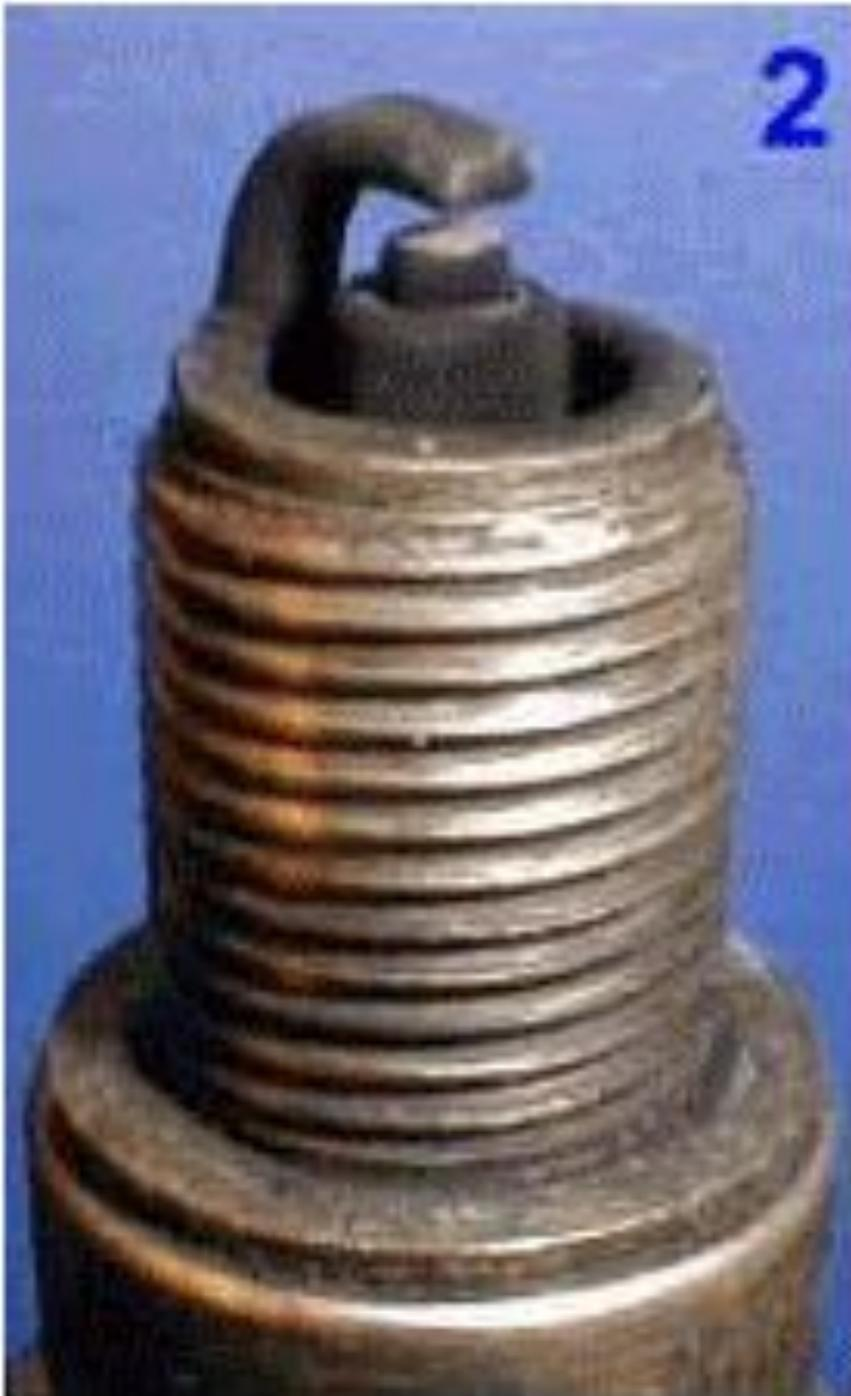
**Фото №2 - типичный пример свечи от двигателя с повышенным расходом топлива. Центральный электрод покрыт бархатисто-черным нагаром. Причин тому несколько: богатая воздушно-топливная смесь (неправильная регулировка карбюратора, угла опережения зажигания или неисправность системы впрыска), засорение воздушного фильтра.**
