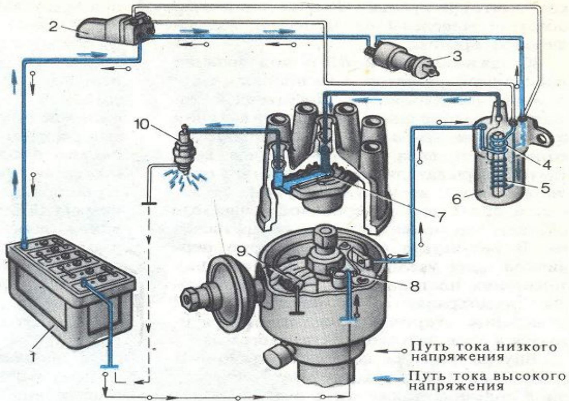
**Также в этой системе присутствуют механизмы корректировки опережения зажигания – центробежный и вакуумный регуляторы.**
