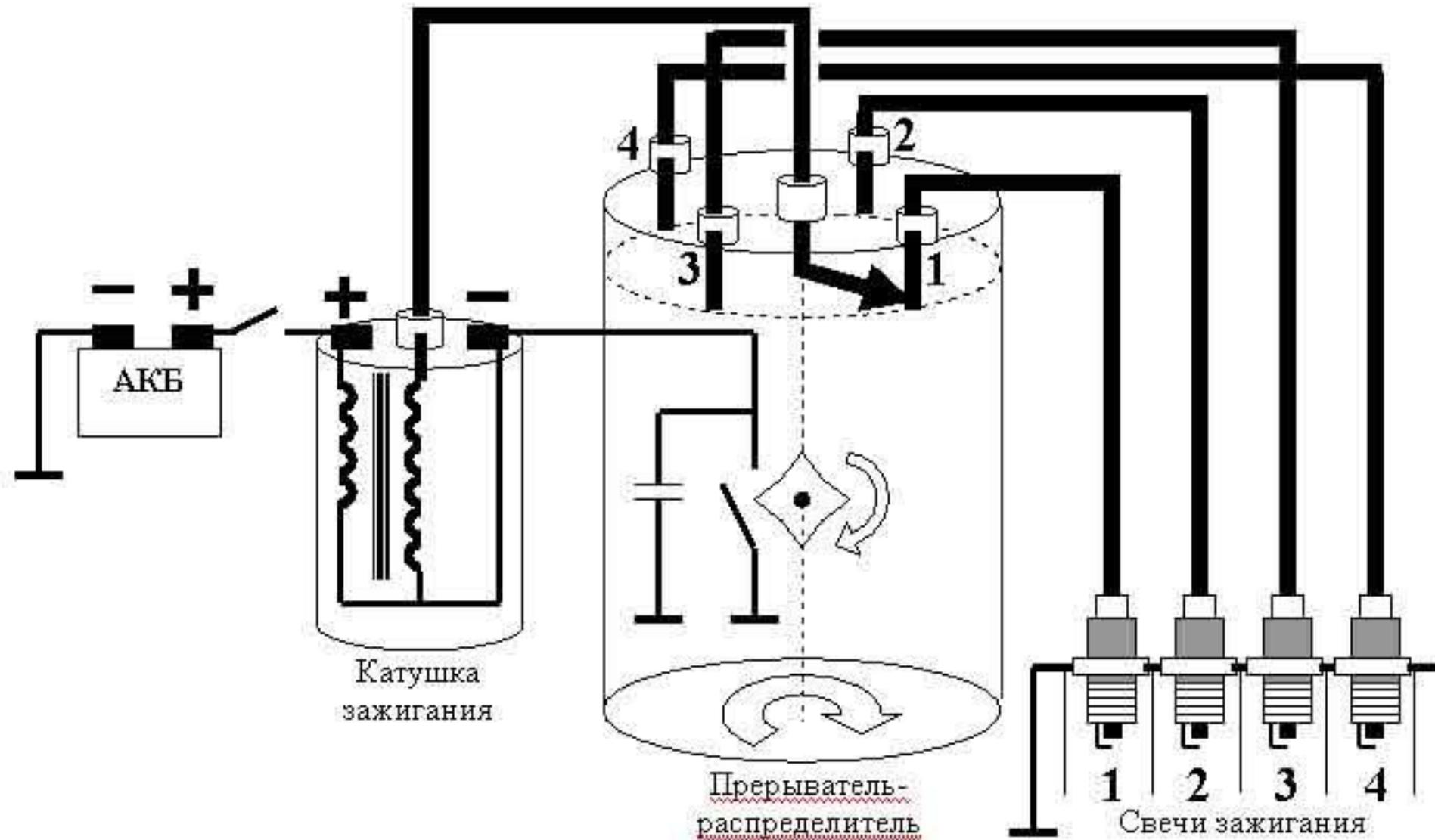
**Кратко принцип работы выглядит следующим образом - питание от бортовой сети подается на первичную обмотку катушки зажигания через механический прерыватель.**
