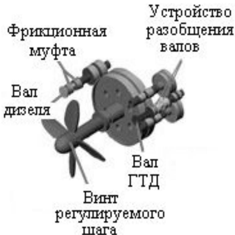
Редукторные передачи для дизелей передают мощность до 25000кВт. Передаточные числа лежат в диапазоне 2...4.
