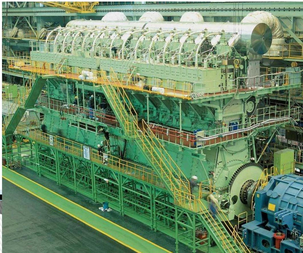
**Дизель Wartsila-Sulzer RT – flex96C мощностью 80080 кВт**
