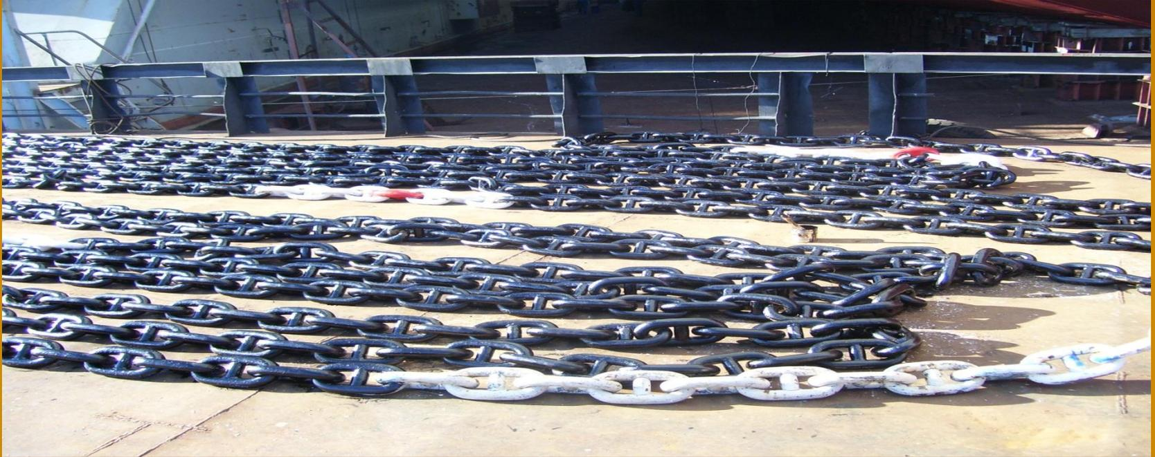
**Держащая сила якоря передается судну через якорный канат, один конец которого прикреплен к якорю, а другой крепится на судне. На судах в качестве якорных канатов применяют цепи. Якорная цепь комплектуется из смычек (якорная, промежуточная, коренная) длиной 25 – 27,5м, которые обязательно маркируются. Якорная смычка должна иметь вертлюг, предотвращающий закручивание цепи, и концевую скобу, соединяемую со скобой якоря.**
