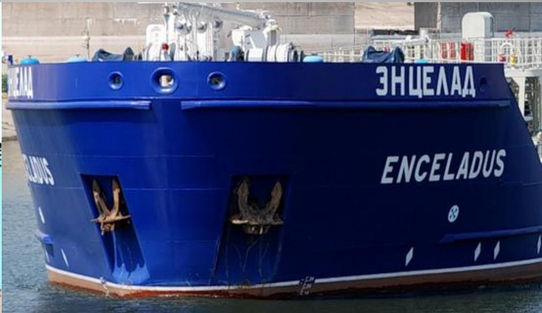
**Якорь** создает держащую силу, способную противостоять силе ветра и течения, зарываясь лапами в грунт. Самоходные суда имеют носовые якоря – становые и кормовой якорь – стоп-анкер.
