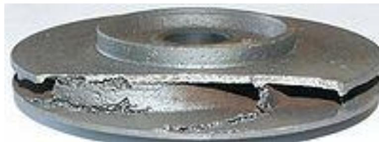
**Кавитационные повреждения рабочих колес гидронасосов**
