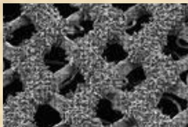
Оксид алюминия термообработанный
