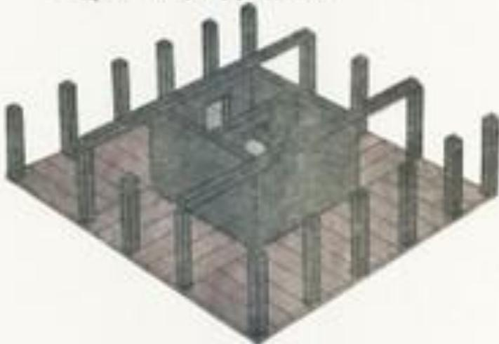
с монолитным ядром жесткости между секциями
