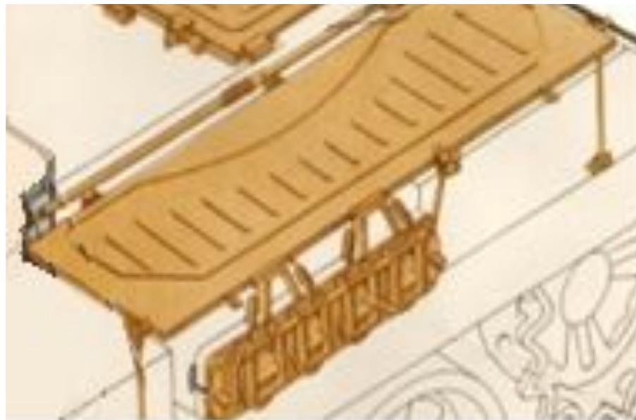
Выпускные клапаны представляют собой панель с четырьмя клапанами, состоящими из тарелки с паронитовой прокладкой и седла. К своим седлам тарелки прижимаются пружинами. Тарелки установлены на валу, на одном конце которого имеется рычаг для открывания клапанов. На панели приварен кронштейн, в котором установлена подпружиненная чека для фиксации клапанов в открытом положении.
