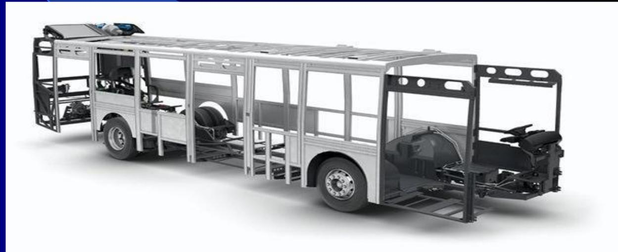
**Металлическая часть кузова включает в себя: днище, крышу, крылья, панели, двери (вместе с замками), капот и крышку багажного отделения.**
