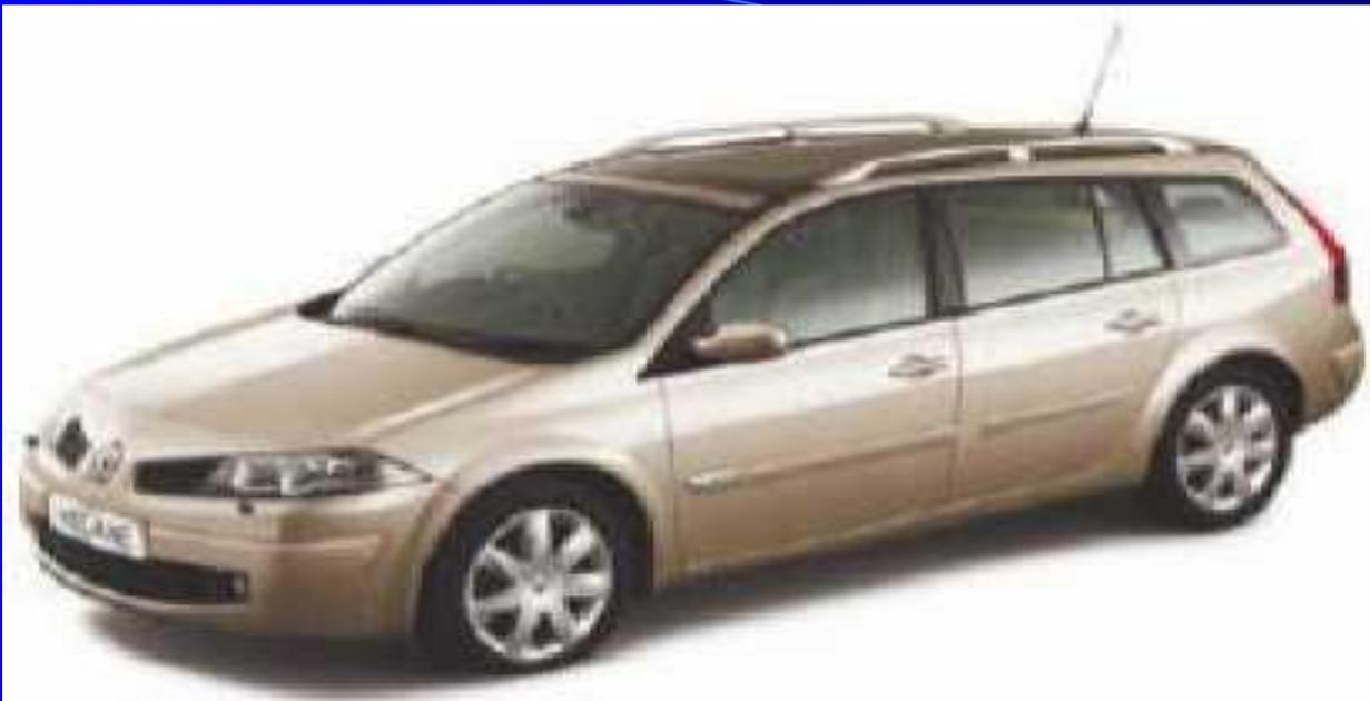
**Универсал** - автомобиль с дверью в задней стенке кузова. Отличается от остальных типов тем, что имеет постоянный грузовой отсек, не отделяющийся от пассажирского стационарной перегородкой.
