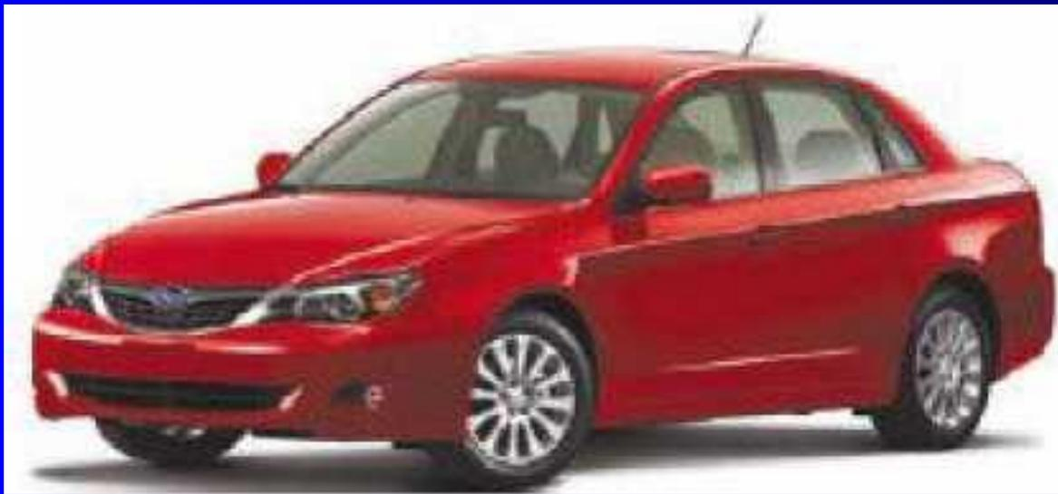
**Седан** - автомобиль с двумя, четырьмя или даже шестью боковыми дверями. Характерные черты - моторный отсек и багажное отделение у седанов вынесены наружу, то есть изолированы от салона.
