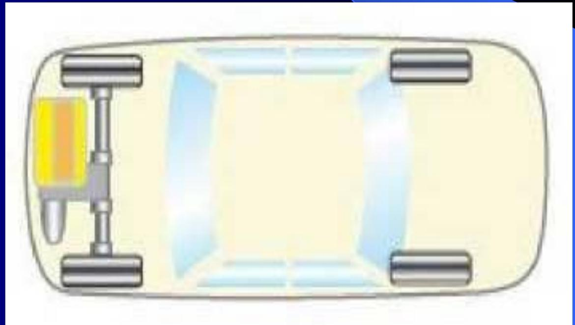
**Полноприводные** - автомобили, в которых крутящий момент передается и на передние, и на задние колеса одновременно.
