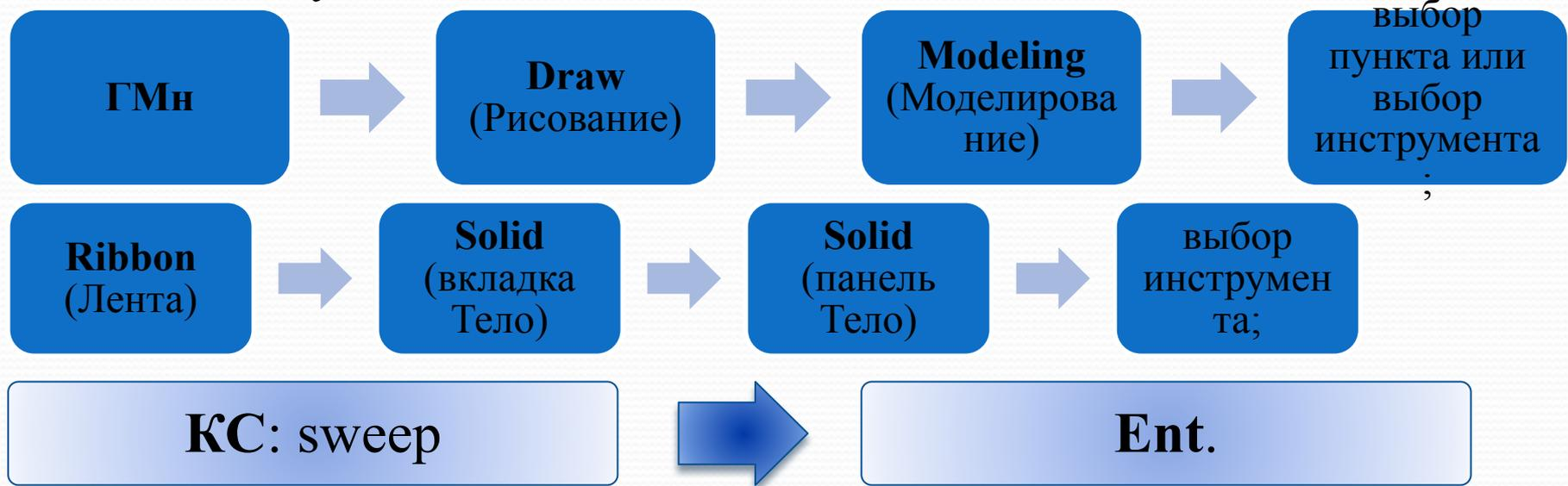
С помощью инструмента **Sweep** (Сдвиг) выполняется проводка исходного контура по указанной траектории. В отличие от выдавливания сдвигаемый объект (объекты) можно скручивать или масштабировать в процессе сдвига. Кроме того, сдвиг допускается применять сразу для набора контуров при условии, что все они расположены в одной плоскости.
