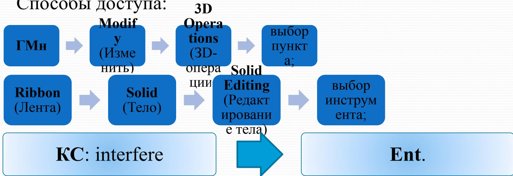
Работа с инструментом **Interference Checking** (Проверка взаимодействий) аналогична работе с известным вам инструментом **Intersect** (Пересечение), но конечный результат применения инструментов различный. Исходные объекты после выполнения процедуры взаимодействия, сохраняются, и это обстоятельство существенно расширяет сферу применения инструмента.
