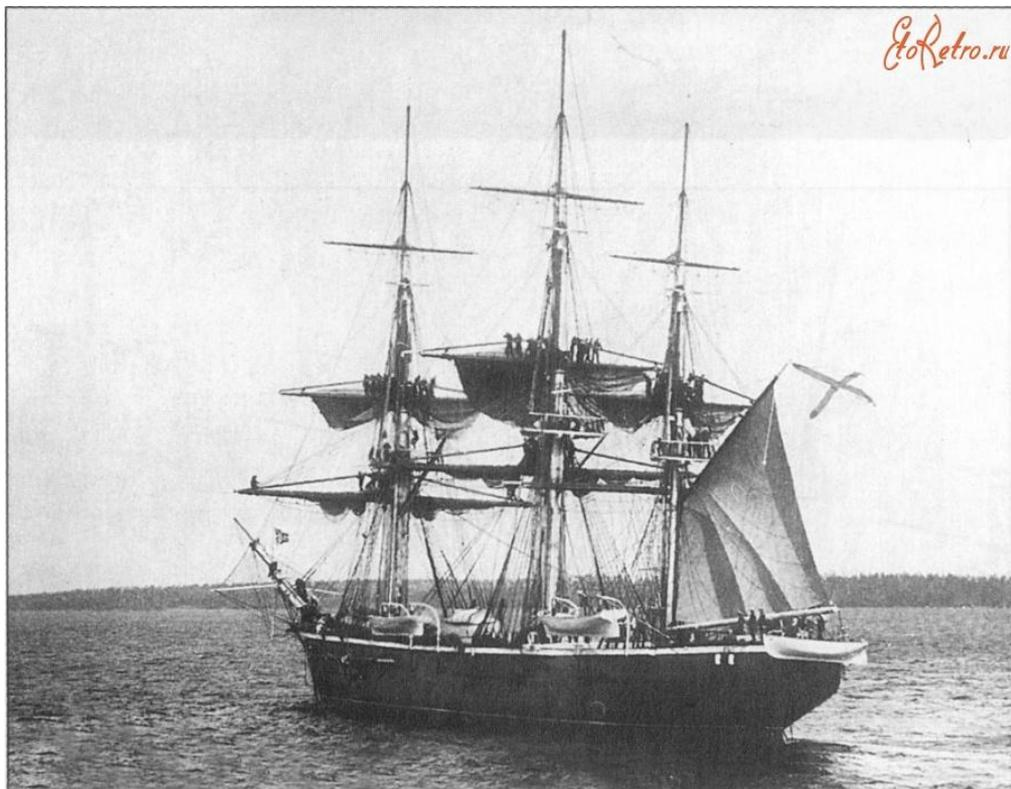
Трёхмачтовый военный корабль XVII—XIX вв. с прямым парусным вооружением, имевший на вооружении 18 — 30 орудий малого и среднего калибра, размещенных только на верхней палубе, и используемый для разведывательной и посыльной службы. Водоизмещение 46 0 тонн и больше. В 40-х гг. XIX в. появились колёсные, а в конце 60-х гг. — парусно-винтовые корветы.
