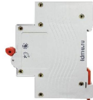
Наличие восьми заклепок позволяет усилить конструкцию аппарата и предотвратить его распиравание при затягивании клеммных винтов. 26
