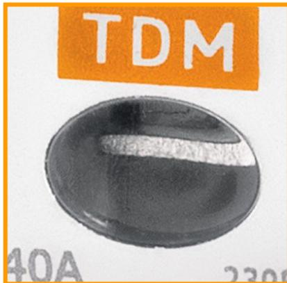
Прозрачное окошко на лицевой панели обеспечивает визуальное наблюдение размыкания контактов («видимый разрыв») для проведения работ на линии.
