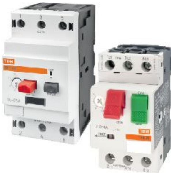
Пускатели ручные кнопочные серии ПРК предназначены для управления и защиты трехфазных асинхронных электродвигателей от перегрузки, коротких замыканий и неполнофазных режимов работы. ПРК имеют регулируемую уставку срабатывания от перегрузки в диапазоне  $0,6 \div 1,0$  номинального тока.
