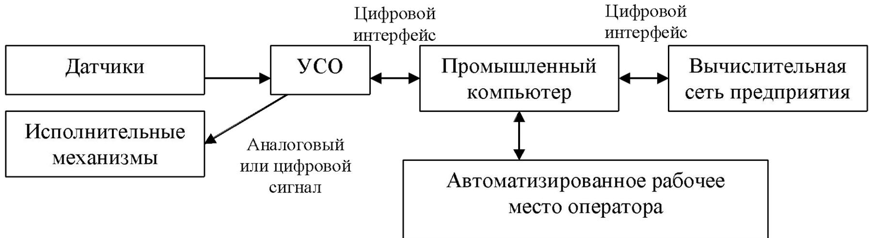
**Промышленные сети** (FieldBus, полевая шина) – компьютерные сети, обеспечивающие информационные потоки между датчиками и разнообразными исполнительными механизмами в АСУ ТП.
