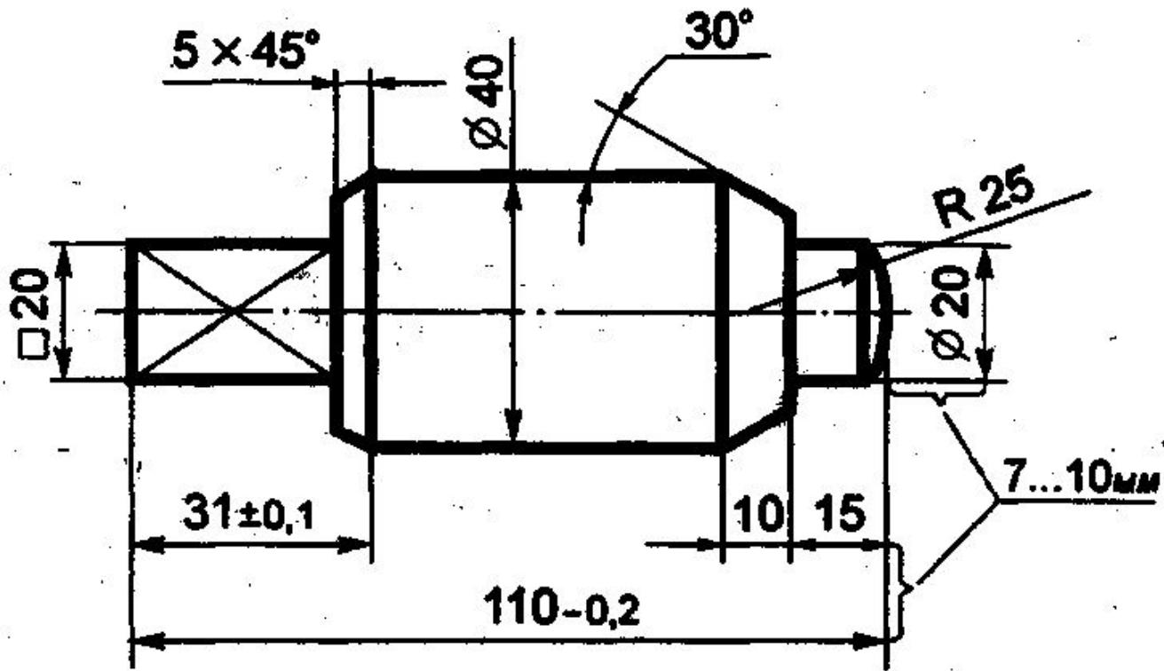
НАНЕСЕНИЕ РАЗМЕРОВ НА
