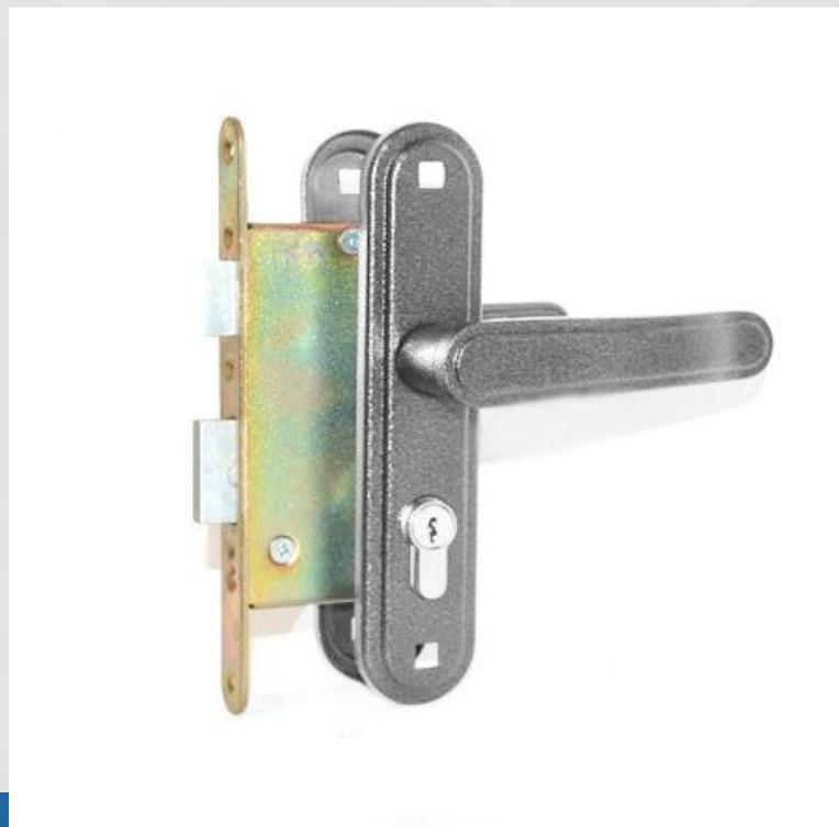
Врезной замок устанавливают в бруске двери на высоте 90-110 см, в вырезанном гнезде. Гнёзда под крепёжную планку и корпус замка предварительно размечают, обводя их контуры. Гнездо под корпус замка вырубают долотом и зачищают стамеской. Для облегчения долбления в бруске предварительно просверливают несколько отверстий диаметром, равным толщине замка. Гнездо под крепёжную планку в
