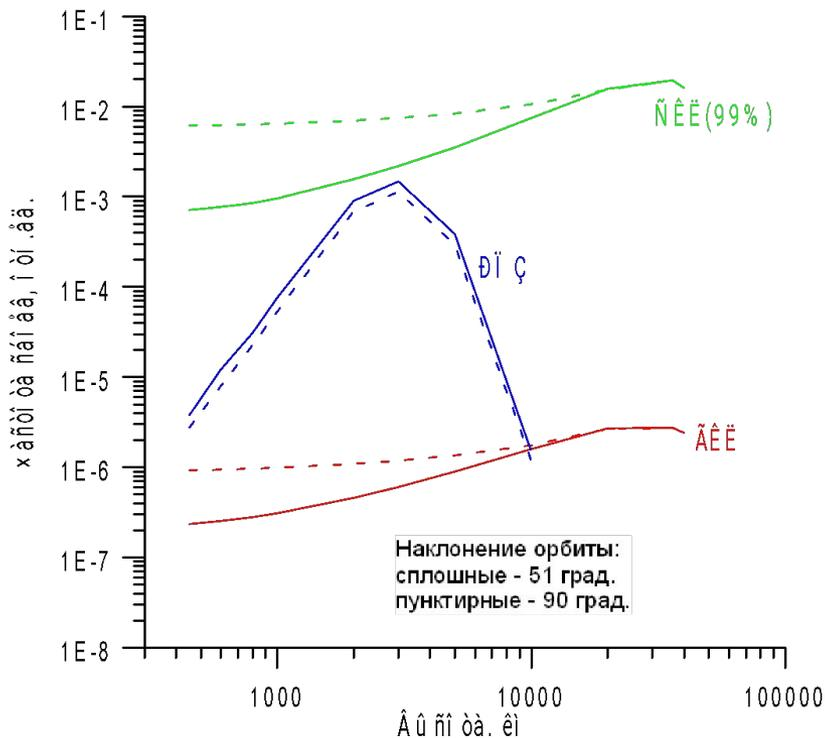
Частота одиночных сбоев в микросхемах памяти в зависимости от высоты круговой орбиты КА (защита 1 г/см<sup>2</sup>)
