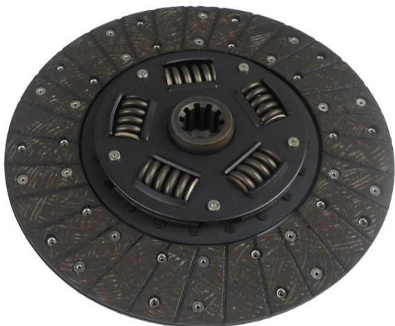
Располагается в зазоре прижимного участка и маховика. Имеет непосредственный контакт с КПП при помощи шлицевой муфты и фрикционных накладок. Вокруг муфты конструктивно находятся демпферные пружины, которые принимают на себя всю вибрацию.
