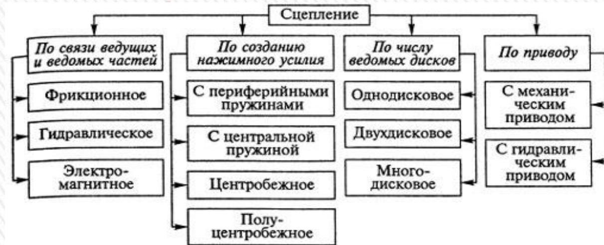
По характеру силы трения существует два вида: сухое и мокрое. Сухое – обеспечивается за счет функциональной работы передачи вращения между двумя шкивами. Мокрое сцепление работает за счет передачи энергии при помощи сжатия компонентов, находящихся в автомобильном масле.
