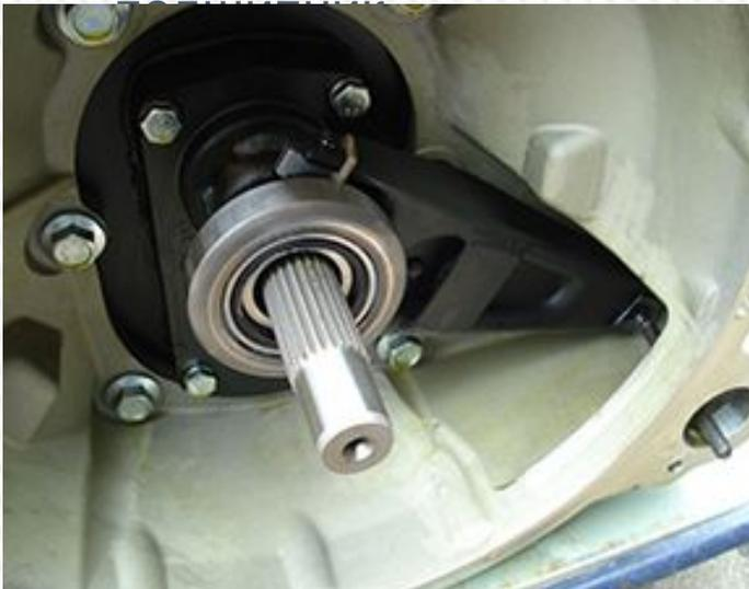
Визуально делится на две части, одна из которых имеет круглую основу для воздействия на пружины корзины. Подшипник расположен на кожухе вала. Существует два типа подшипников: оттягивающего или нажимного принципа. Первый тип нашел свое применение в Peugeot. Иногда подшипник имеет несколько пружин-фиксаторов.
