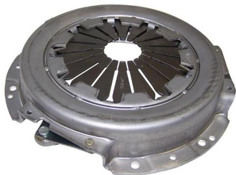
Является основой для других конструктивных элементов сцепления. Имеет непосредственный контакт с выжимными пружинами, которые направлены к центру. Размер площадки пропорционален двум радиусам маховика ДВС. Нажимной участок отличается наличием шлифовки исключительно с одной стороны. Диск имеет плотное соединение с маховиком двигателя.
