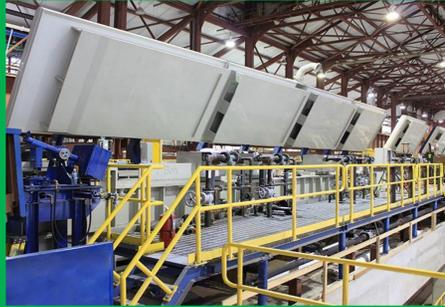
Данная технологическая схема производства продукции обеспечивает наиболее экономный расход воды, кислоты, стабильный технологический процесс травления и стабильное качество промывки, полное отсутствие отходов в виде отработанной соляной кислоты, отсутствие сточных вод (замкнутый цикл производства) и вредных выбросов в атмосферу, что снижает экологическую нагрузку предприятия, а также улучшает условия труда работников предприятия.
