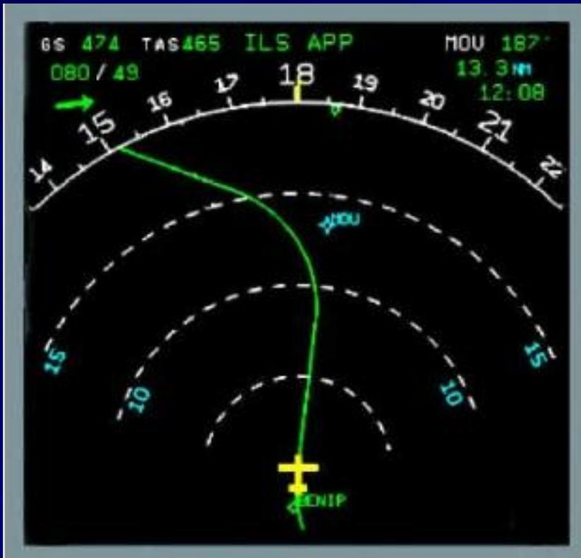
Этот режим показывает сектор 90 градусов передней части самолета. Символ самолета находится по центру нижней части зоны карты. Полетная информация планирования и погодных условий отображаются как в режиме навигация.
