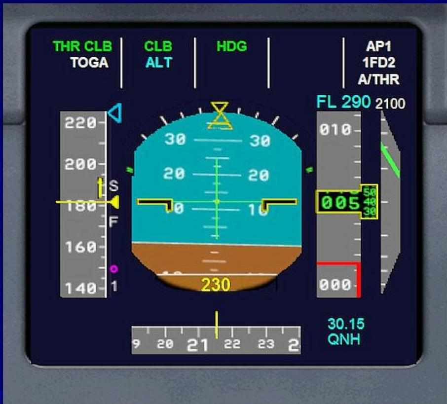
**Секция скорости полета.** Эта секция связана с управлением скоростью полета. Треугольник показывает заданную или автоматически управляемую скорость. Он окрашен в пурпурный цвет, если режим автоматического управления скоростью не активирован, в противном случае он окрашен в синий цвет
