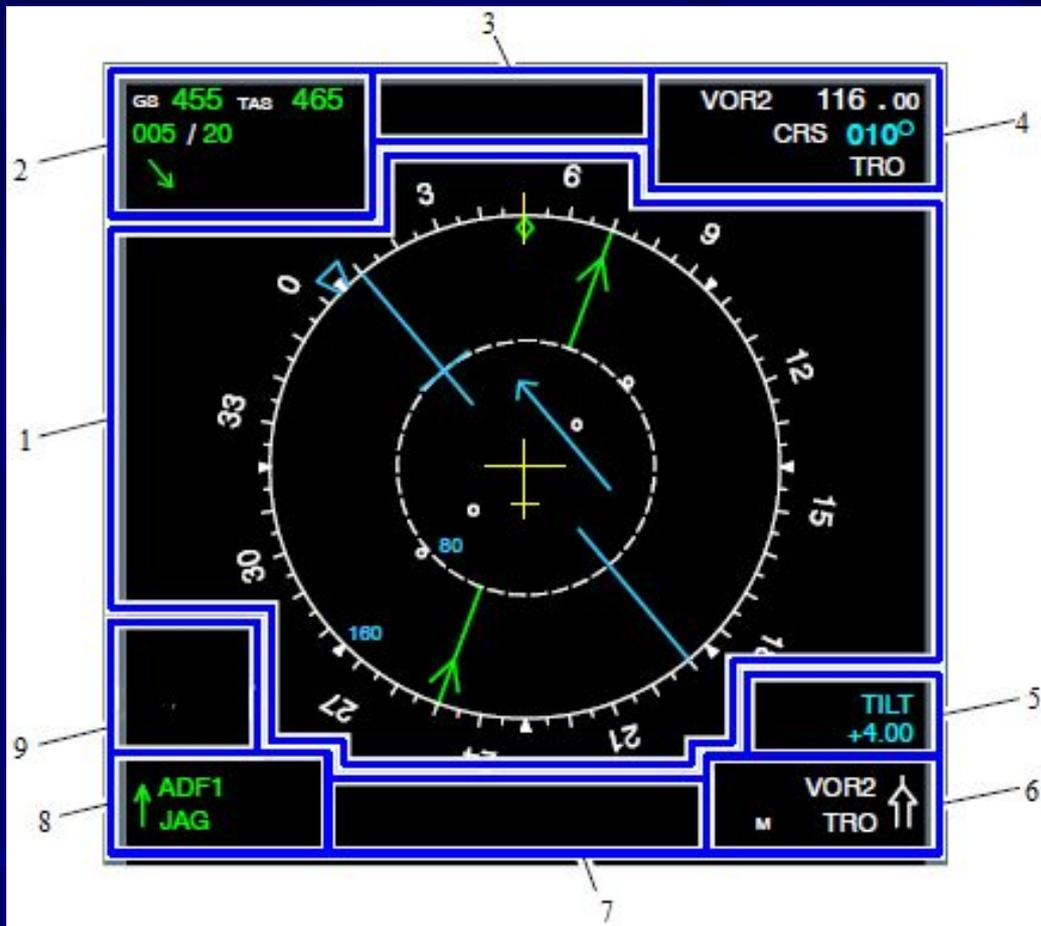
ND является основным инструментом навигации. Он отображает путь, заданный в системе GPS. Навигационные средства и аэропорты расположенные вокруг самолета, а также информация системы предупреждения столкновений (TCAS, traffic collision avoidance system), которая отображает все другие близкие самолеты, представляющие потенциальную опасность.
