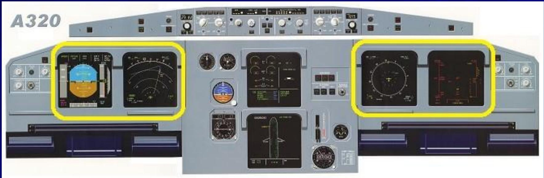
Левая часть предусмотрена для командира воздушного судна, правая для второго пилота. В каждой части по два индикатора: основной пилотажный и навигационный дисплеи.
