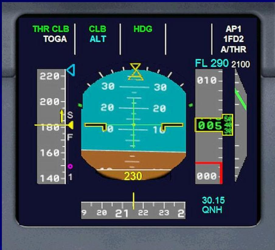
Пятая колонка отображает активированные автоматические режимы: AP1 – главный автопилот, 1FD2 – автомат курса, A/THR – автомат тяги. A/THR отображается синим, если рычаг управления тягой находится в положении CL (тяга для набора высоты), FLX (режим взлета FLEX) или TOGA (режим взлета/ухода на второй круг). Он отображается зеленым при активации.
