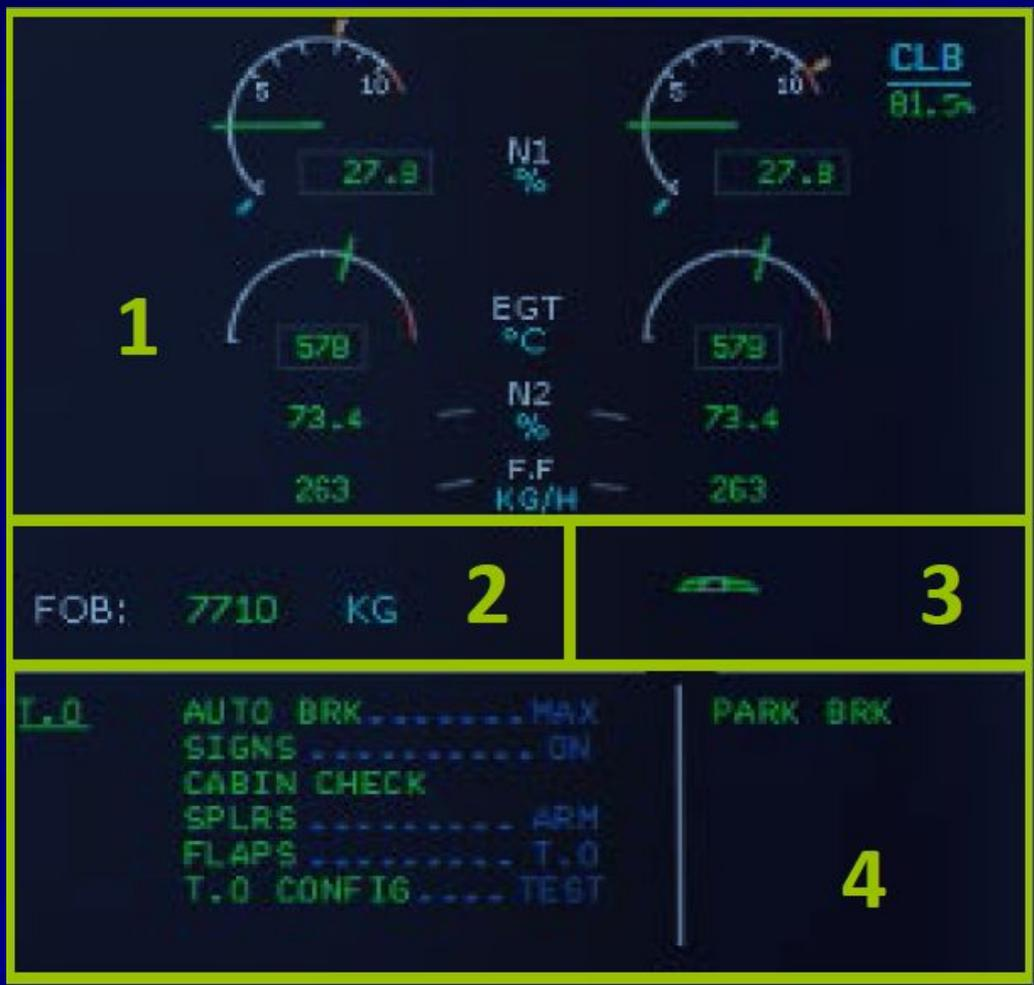
Дисплей состояния двигателей и системных сообщений, предупреждений условно разделен по горизонтали на две части. Верхняя часть занимает две трети дисплея и отображает показатели состояния двигателей, количество топлива на борту, а также положение клапанов. На нижнюю часть дисплея выводятся системные сообщения и предупреждения.
