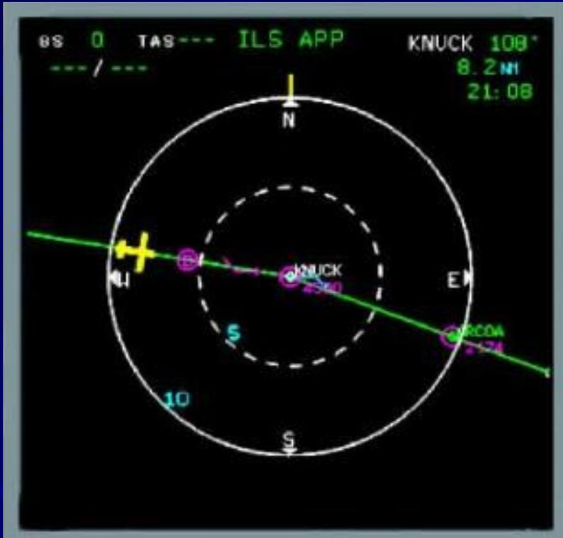
В этом режиме карта отображается строго по сторонам света. В середине экрана отображается следующая путевая точка, как точки отсчета. В зависимости от выбранного диапазона путевых точек планируется траектория полета и отображается на дисплее. Символ самолета отображается в соответствии с действующим положением воздушного судна.
