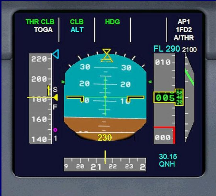
Колонка 3 показывает режим навигации. Если выбран режим «Направление движения» (Heading) блока управления полетом (Flight control unit, FCU), отображается надпись HDG. Если выбран режим «Автопилота по крену» (Wing leveler) блока управления полетом (Flight control unit, FCU), отображается надпись LVL.
