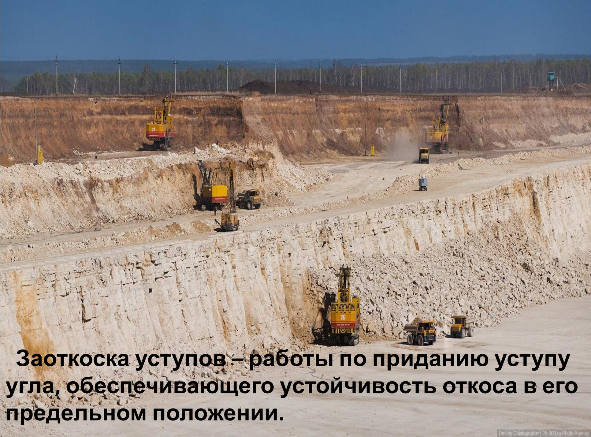
**Заоткоска уступов – работы по приданию уступу угла, обеспечивающего устойчивость откоса в его предельном положении.**
