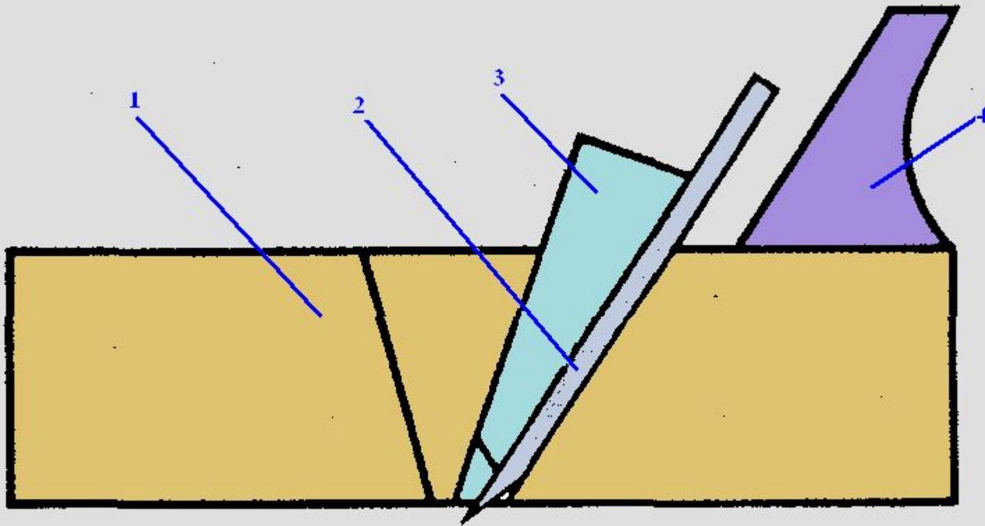
Рис.3. Устройство рубанка. 1 - колодка; 2 - нож; 3 - клин; 4 - ручка.
