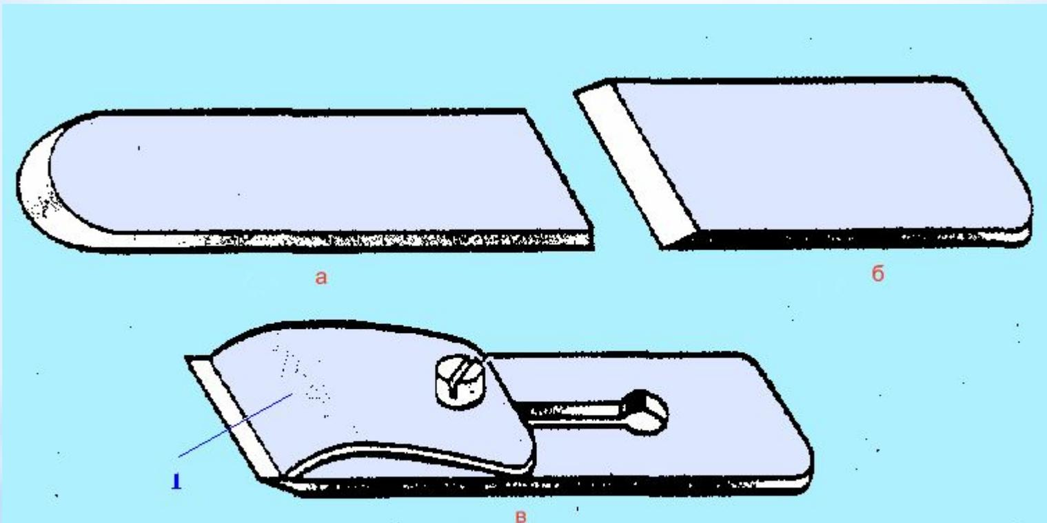
Рис.2. Ножи: а - шерхебеля; б - рубанка; в - рубанка с стружколомателем;
