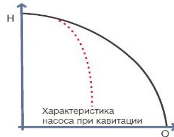
Рис. 2.2.11: Характеристика насоса при кавитации
