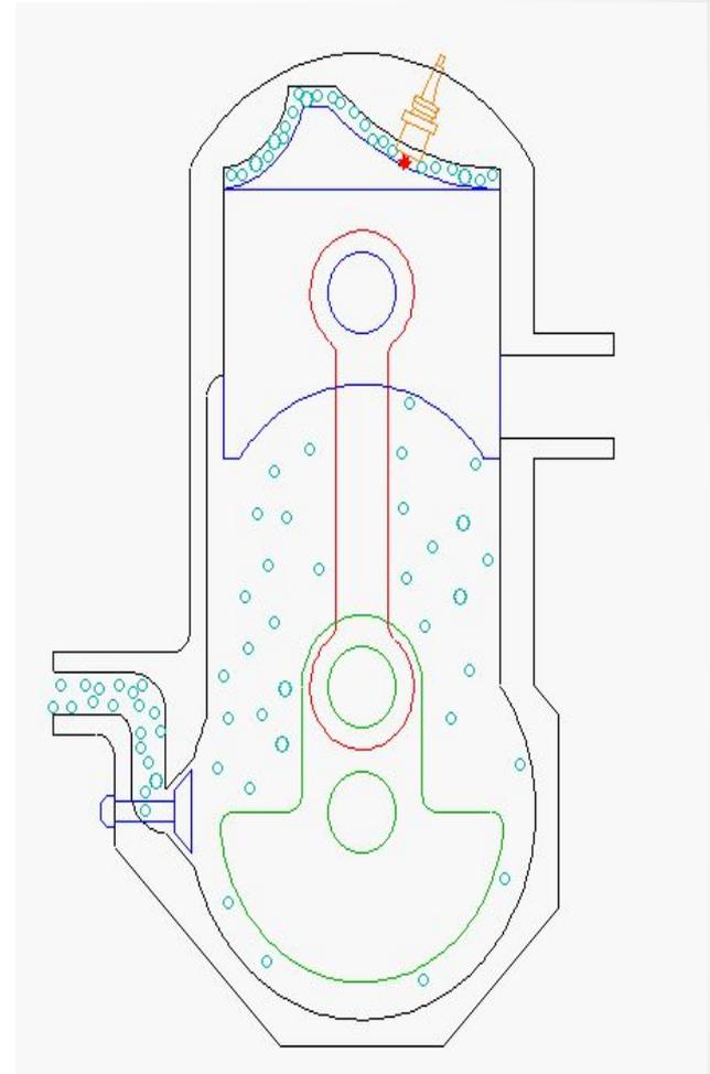
Работа двухтактного дизельного двигателя.
