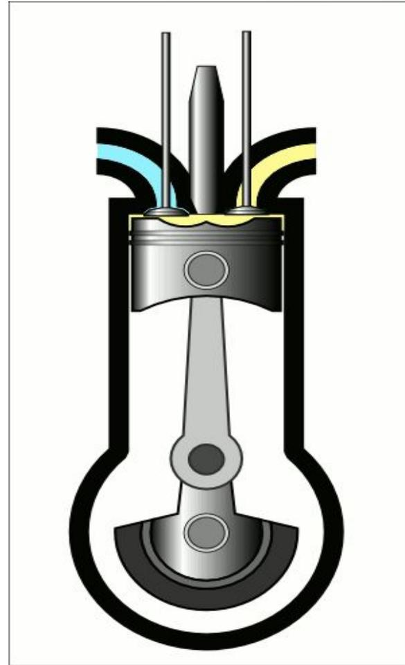
Работа четырёхтактного дизельного двигателя.
