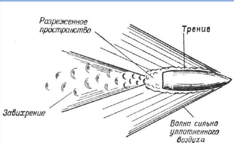
**Сила сопротивления воздуха** вызывается трением воздуха, образованием завихрений и образованием баллистической волны.
