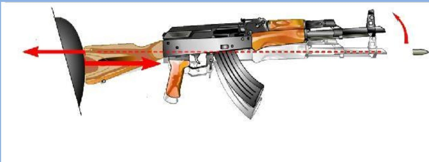
Сила отдачи и сила сопротивления отдаче (упор приклада) расположены не на одной прямой и направлены в противоположные стороны. Они образуют пару сил, под воздействием которой дульная часть ствола оружия отклоняется квер-ху. Величина отклонения дульной части ствола оружия тем больше, чем больше плечо этой пары сил.
