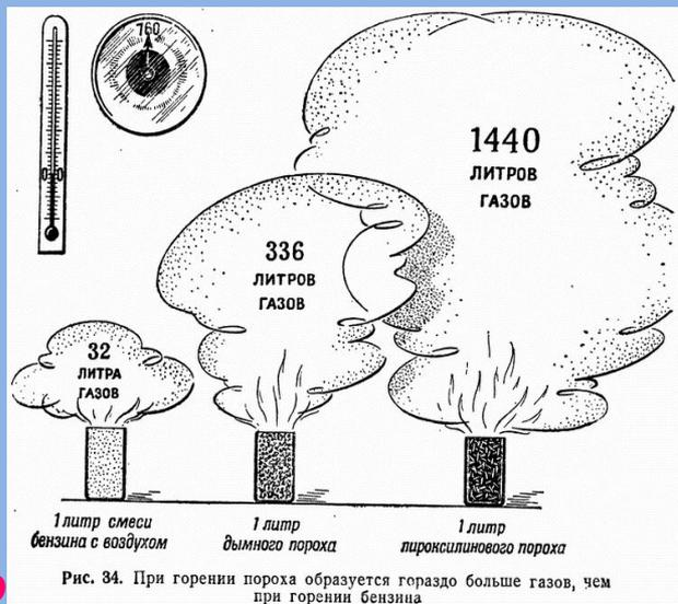
Рис. 34. При горении пороха образуется гораздо больше газов, чем при горении бензина
