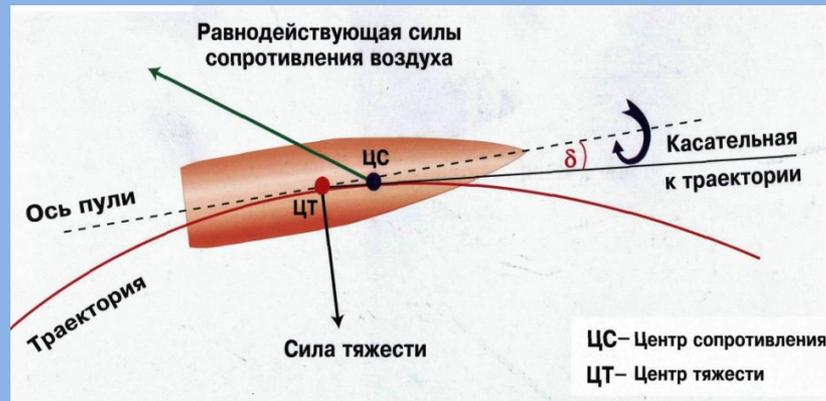
Чем глаже поверхность пули, тем меньше сила трения и сила сопротивления воздуха. Под действием начальных возмущений (толчков) в момент вылета пули из канала ствола между осью пули и касательной к траектории образуется угол ( $\delta$ ) и сила сопротивления воздуха действует не вдоль оси пули, а под углом к ней, стремясь не только замедлить движение пули, но и опрокинуть ее.
