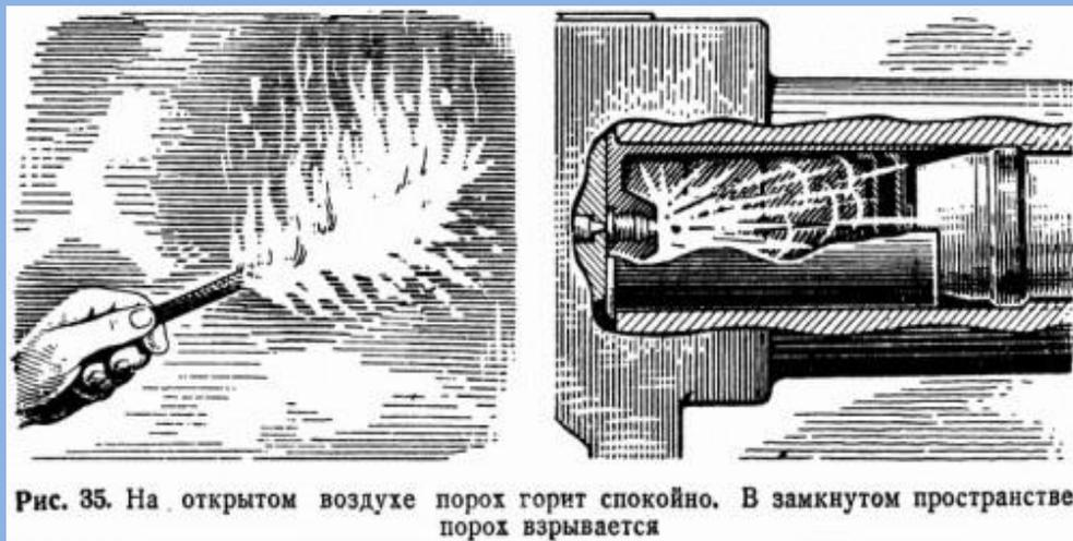
Рис. 35. На открытом воздухе порох горит спокойно. В замкнутом пространстве порох взрывается
