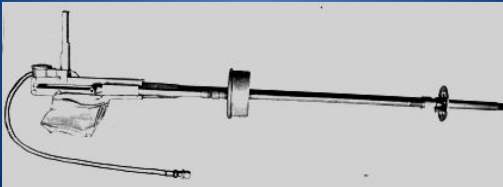
Вкладная пушка 2Х35 размещается в зарядной камере и казённом танковой пушки, и устанавливается имитатором поддона в начале первого конуса камеры. Запирание ствола пушки осуществляется штатным клином.
