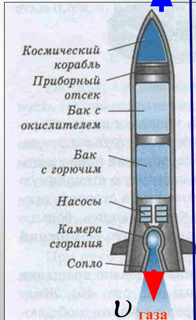
В любой ракете всегда имеется: оболочка и топливо с окислителем. Основную массу ракеты составляет топливо с окислителем. Топливо и окислитель с помощью насосов подается в камеру сгорания. Топливо, сгорая, превращается в газ высокой температуры и высокого давления. Благодаря большой разности давления в камере сгорания и в космическом пространстве, газы с камеры сгорания мощной струей устремляются наружу через сопло.
