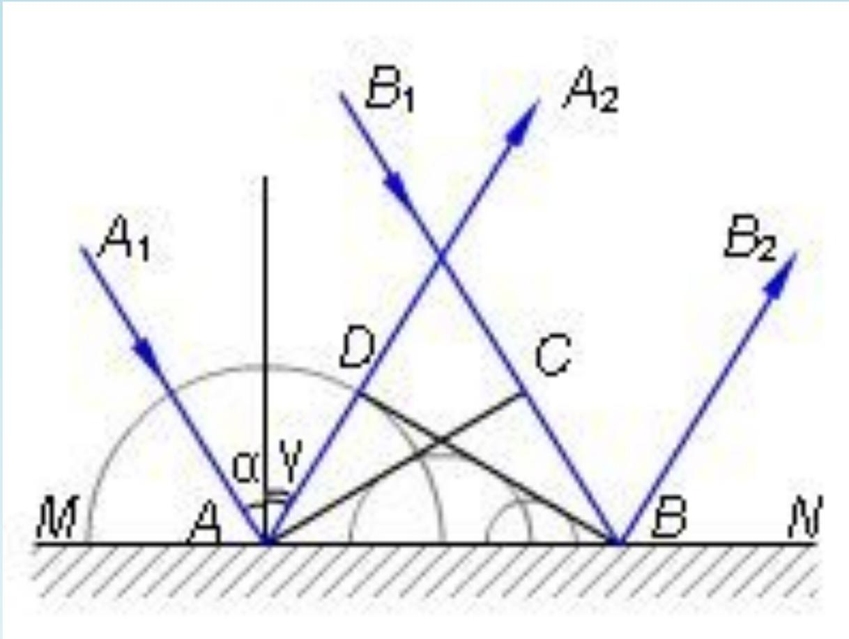
Так как  $AD = CB$  и треугольники  $ADB$  и  $ACB$  – прямоугольные, то  $\angle DBA = \angle CAB$ . Но  $\alpha = \angle CAB$  и  $\gamma = \angle DBA$  как углы с перпендикулярными сторонами. Следовательно, угол отражения равен углу падения:
