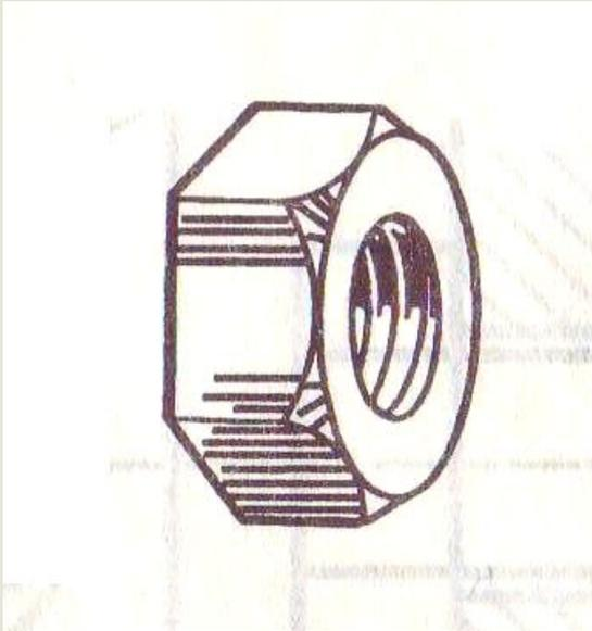
Деталь со сквозным отверстием, имеющим резьбу, используемая для навинчивания на стержень болта с такой же резьбой.
