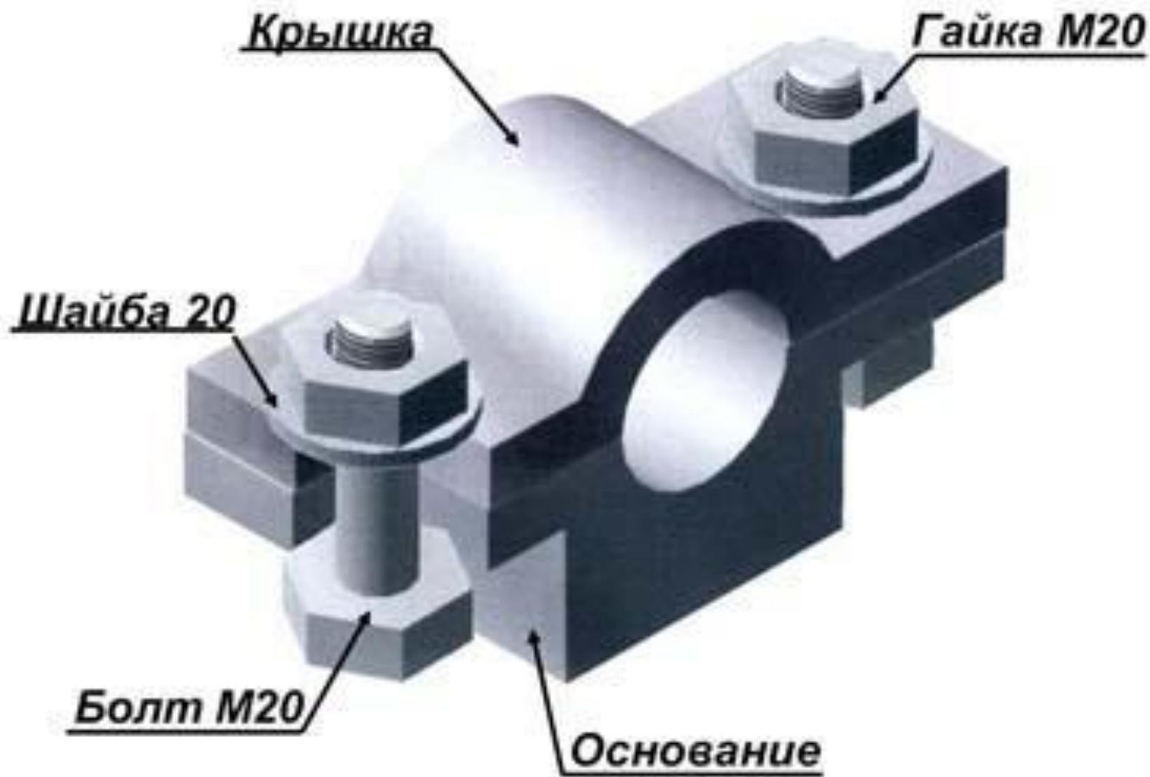
При **обозначении** для болтов указывают диаметр и тип резьбы, длину стержня и номер стандарта
