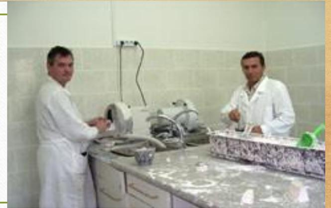
В гипсовочной комнате производят отливку моделей, гипсовку в кюветы, окклюдаторы и артикуляторы, освобождают готовые пластмассовые протезы от гипса после полимеризации, гипсуют металлические детали, подлежащие спайке. Оборудование состоит из гипсовочной установки, бункера для хранения небольшого запаса гипса, дозатора гипса, стола с обычным прессом и прессом для выдавливания гипса из кювет, в ящиках которого хранят кюветы и бюгели, окклюдаторы и артикуляторы.
