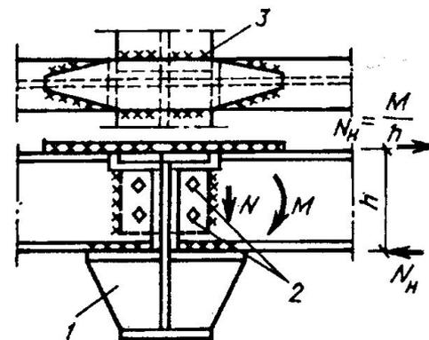
Рис. 7.33. Жесткое сопряжение балок
