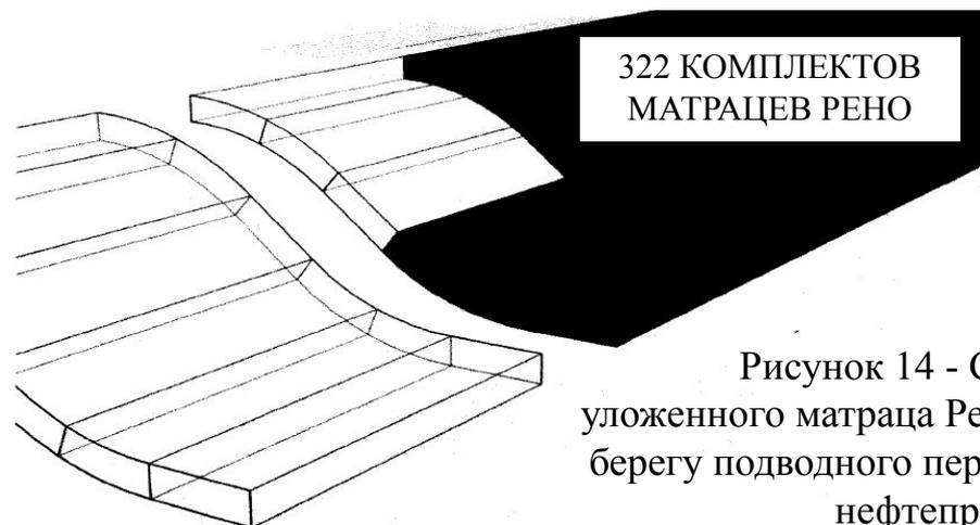
Рисунок 14 - Схема уложенного матраца Рено на берегу подводного перехода нефтепровода
