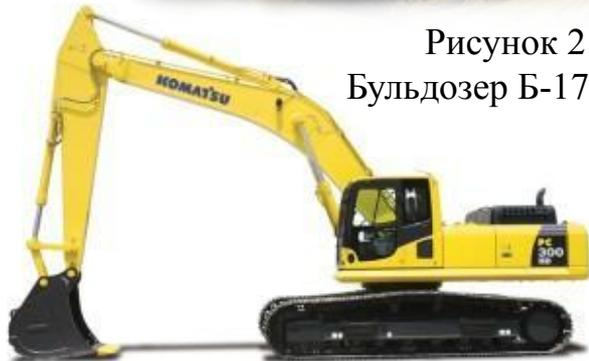
Рисунок 3 - Экскаватор Komatsu PC-300
