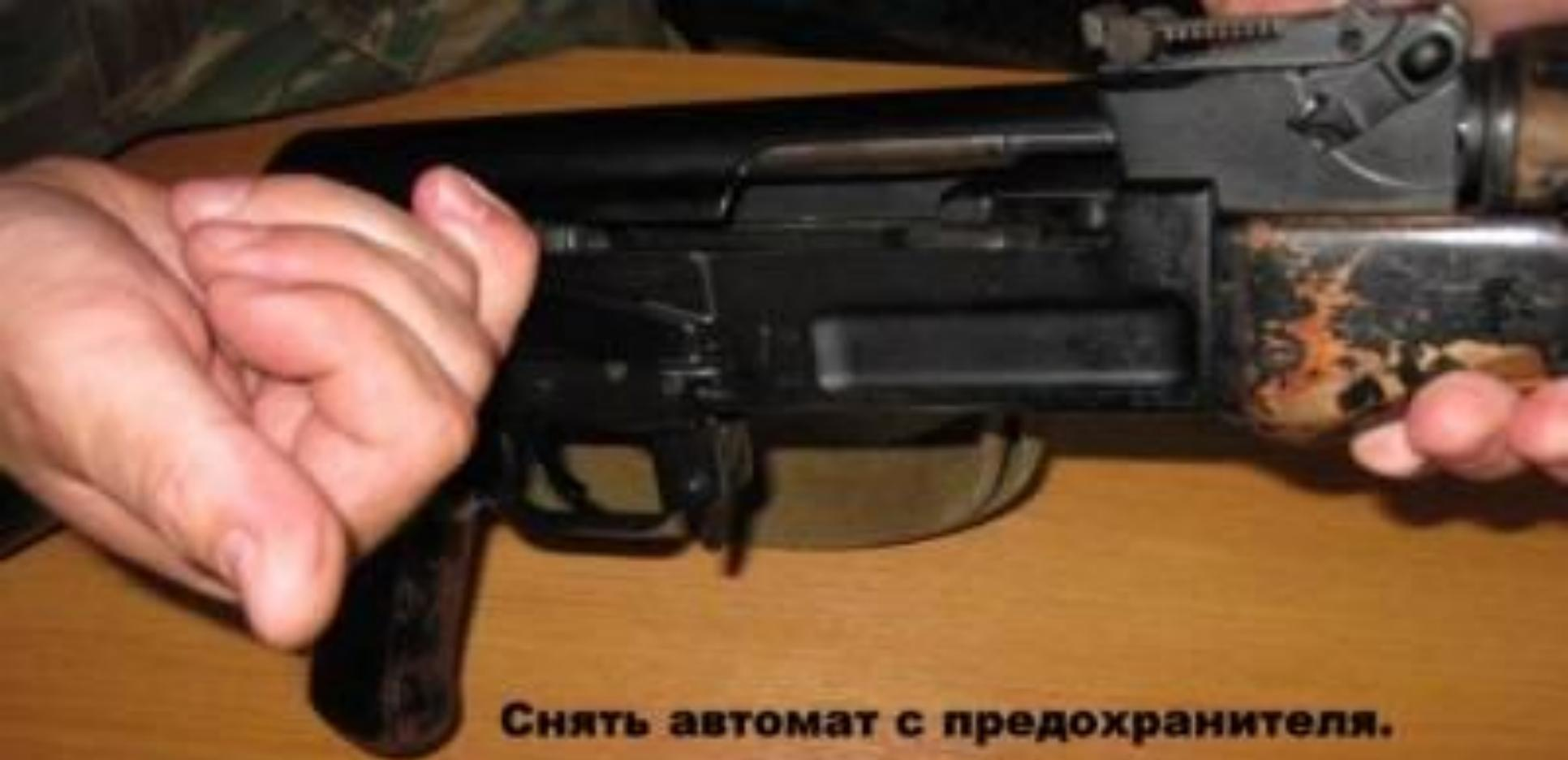
**Снять автомат с предохранителя.
