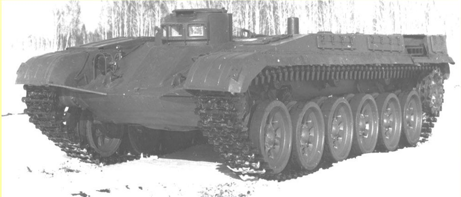
Рис. 3.1. Гусеничное бронированное шасси машины разграждения (общий вид)
