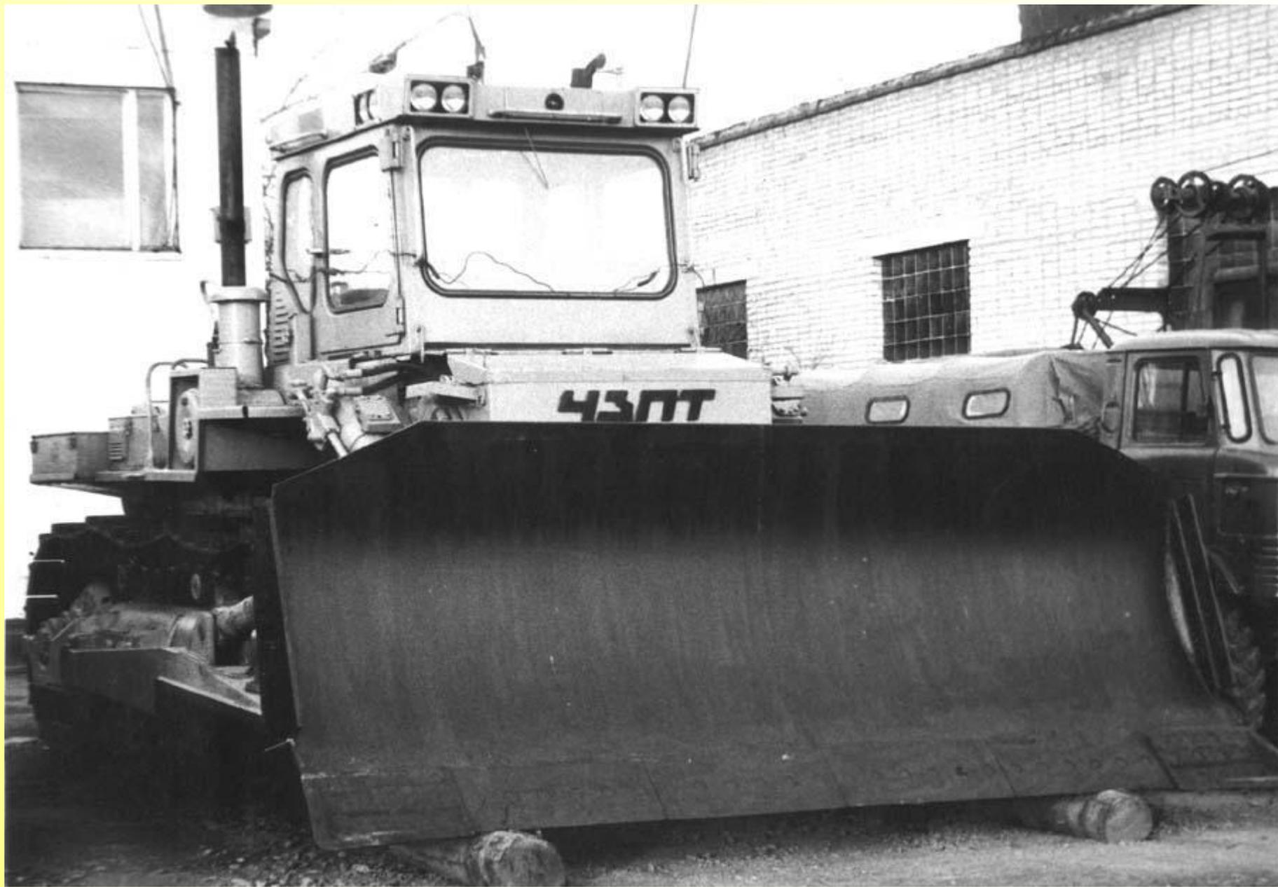
Бульдозер ДЗ-59 на базовом тракторе Т-330
