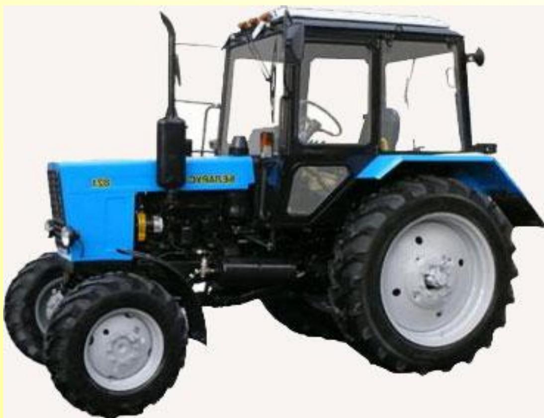
Колесный универсально-пропашной трактор МТЗ-80
