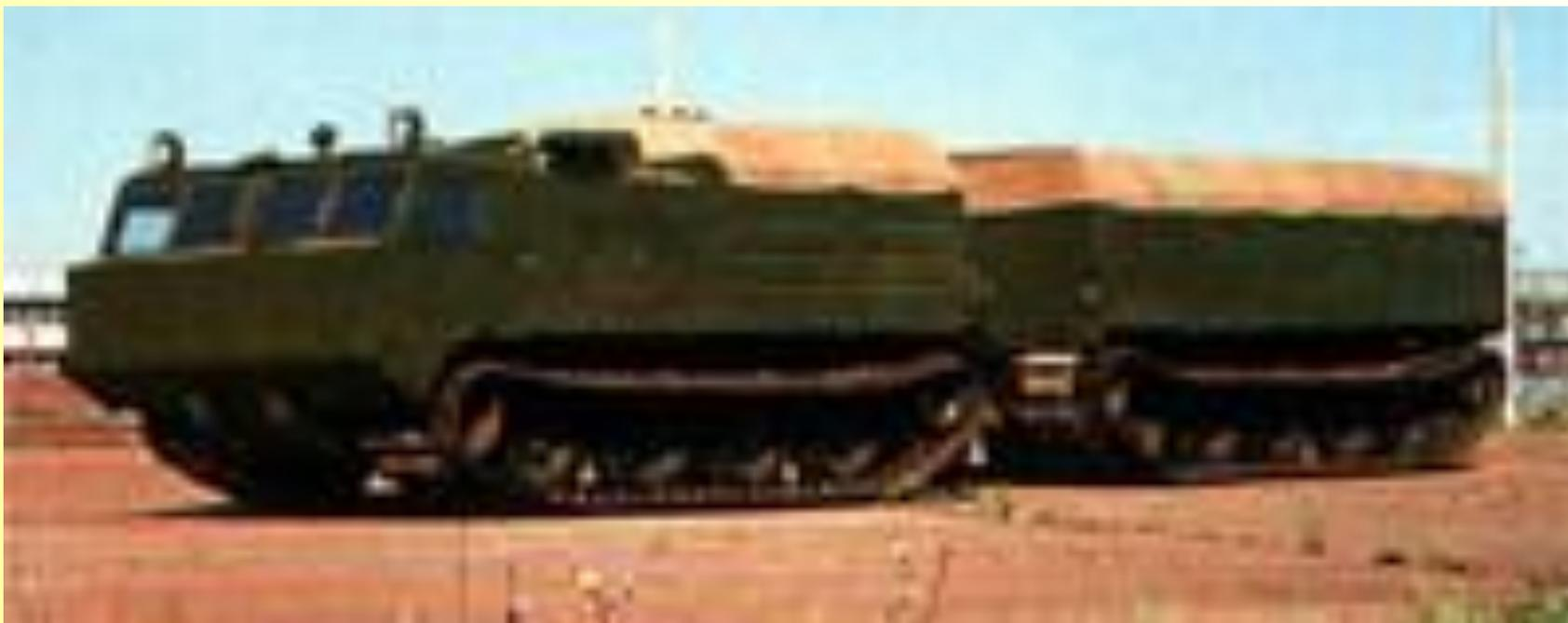
Предназначен для перевозки различных грузов в особо тяжелых дорожных условиях районов Севера, Сибири и Дальнего Востока. Может быть использован в качестве шасси под монтаж различного технологического оборудования. Отличается высокими показателями проходимости, маневренности и живучести.
