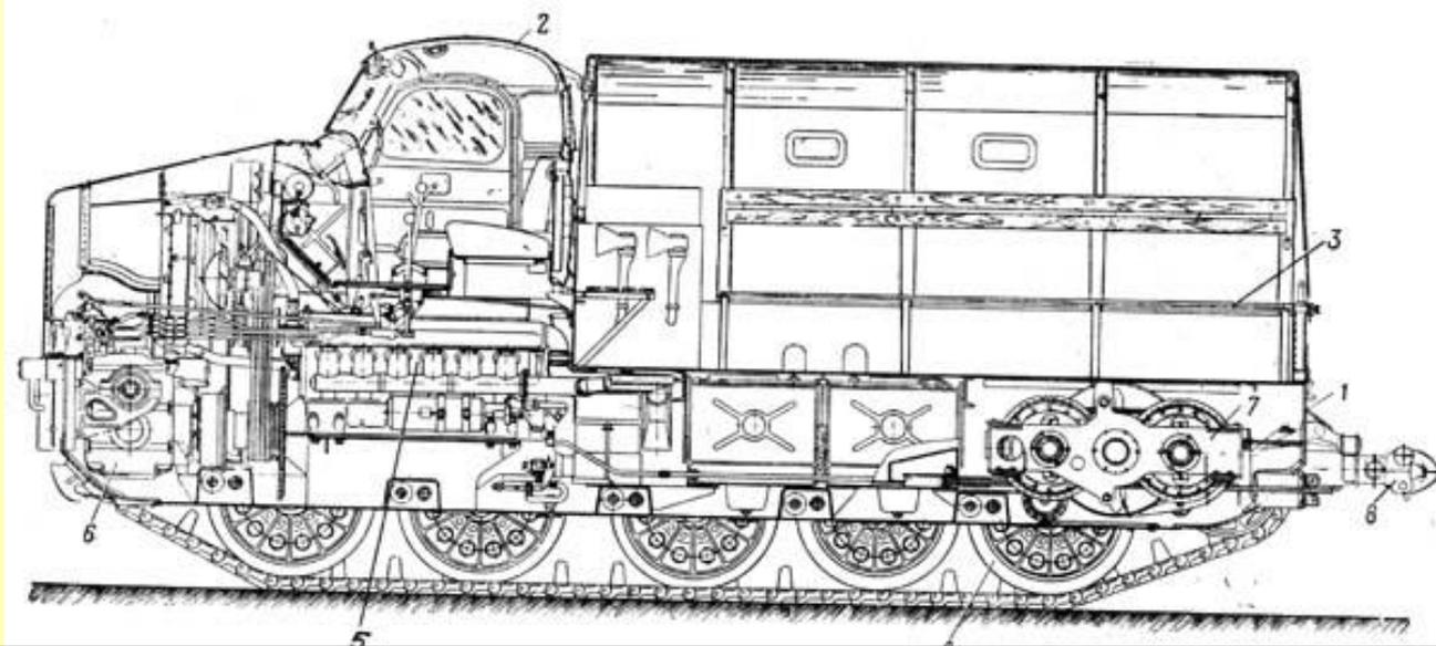
1 — коробка передач с механизмом поворота — двухступенчатый ПМП;
