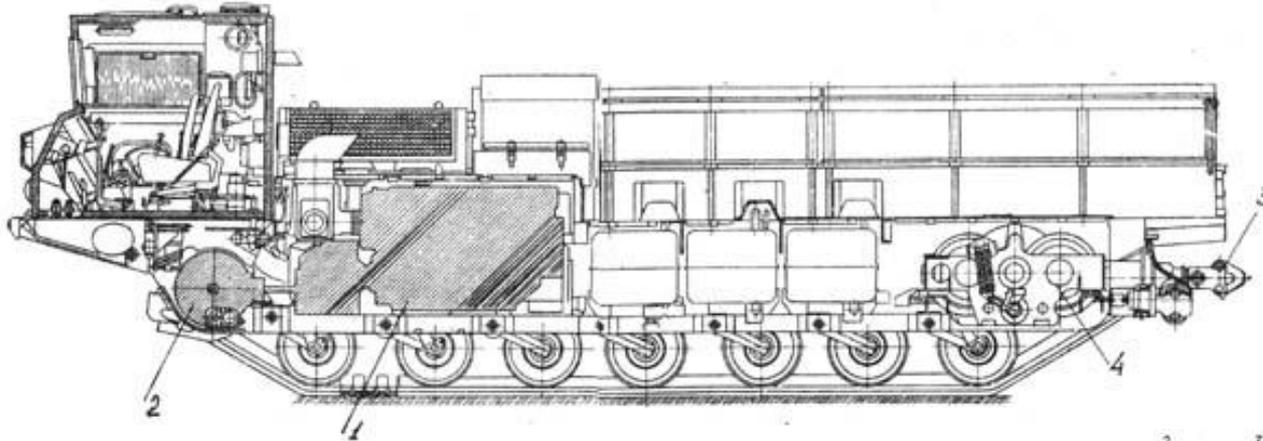
1 — двигатель; 2 — механизм поворота «бортовые коробки передач»; 3 — тягосцепной прибор; 4 — лебедка
