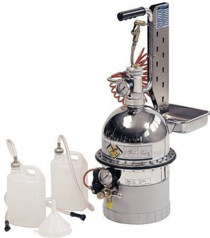
Оборудование для заливки и прокачки гидравлических тормозов автомобилей
