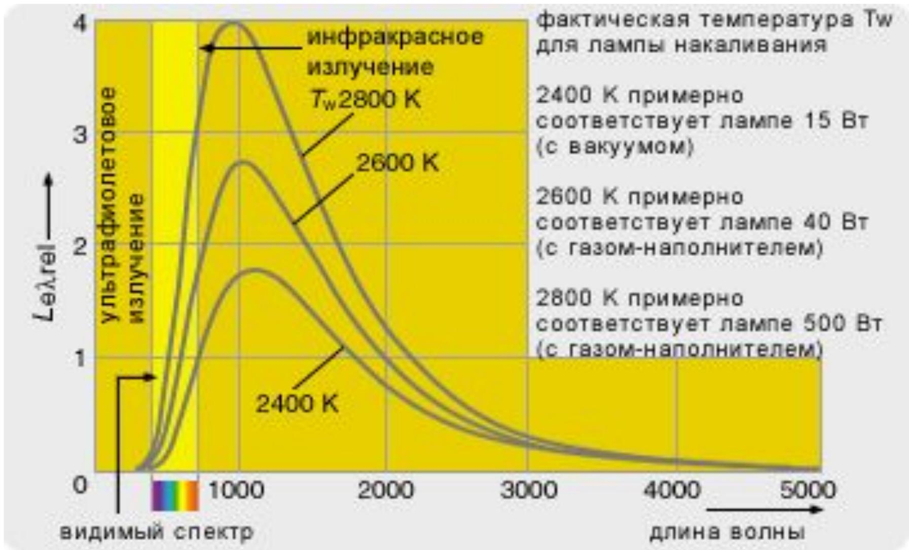
**Рис. 9. Относительное спектральное распределение плотности излучения лампы накаливания**
