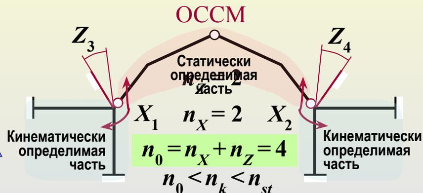
**Основная система смешанного метода (ОССМ)** – геометрически неизменяемая система, получаемая из рассчитываемой СНС удалением лишних связей, реакции которых принимаются за силовые основные неизвестные  $X$ , и введением угловых и линейных связей в расчётные узлы, перемещения которых принимаются за неизвестные  $Z$ .
