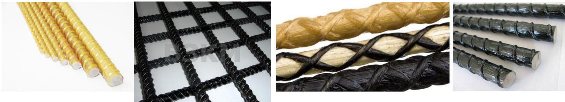
**Базальтопластиковая и углепластиковая** разновидности отличаются повышенной стойкостью к агрессивным средам. Стоят они дороже первого вида, поэтому арматура из стеклянных волокон применяется в строительных операциях чаще. У композитного материала низкая огнестойкость. Пластик начинает плавиться при температуре +160 °С.
