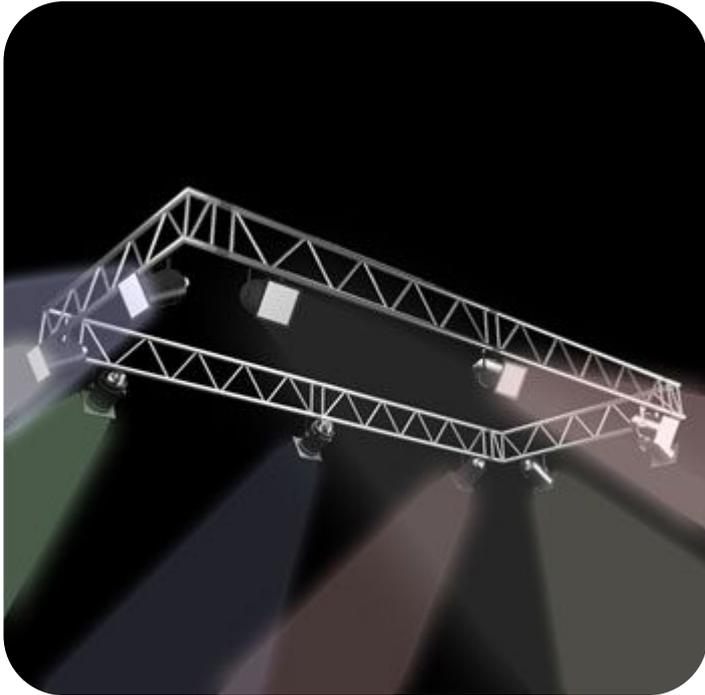
Рисунок 1 – Металлическая конструкция для освещения из плоских ферм
