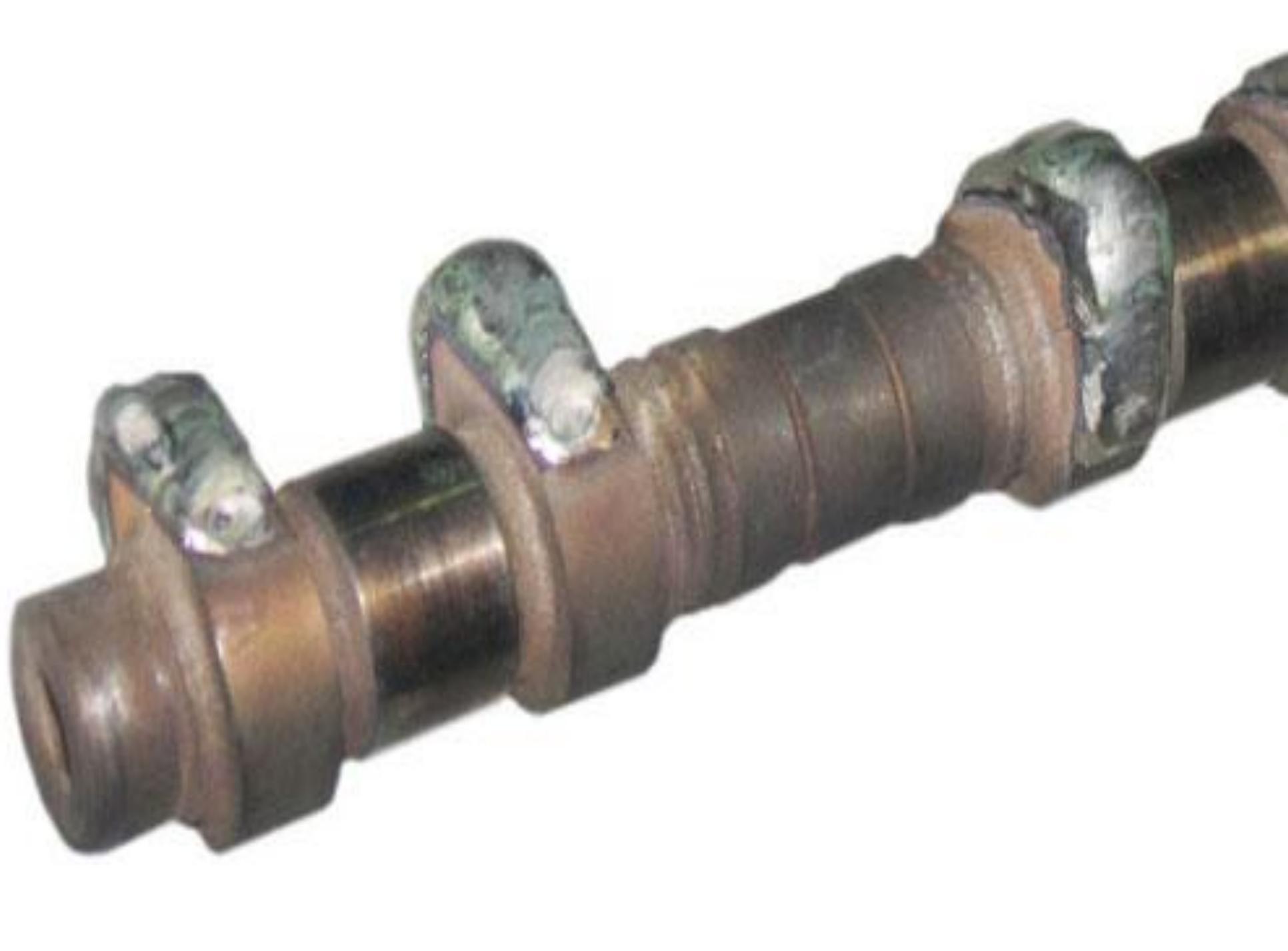
Применяются различные способы наплавки металла – электродуговая, газовая, электрошлаковая, индукционная, плазменная, импульсно-дуговая, вибродуговая, порошковая наплавки.
