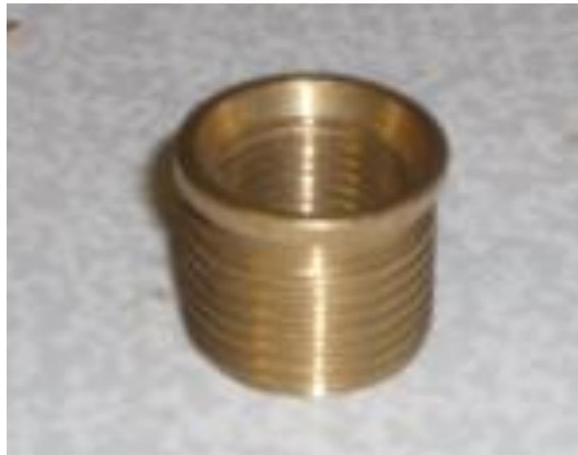
Ремонт гладких отверстий постановкой ремонтной втулки является наиболее простым и распространенным способом. Примерами такого способа ремонта являются места посадки наружных колец подшипника качения в корпусах коробок передач, раздаточных коробках, ступицах колес.
