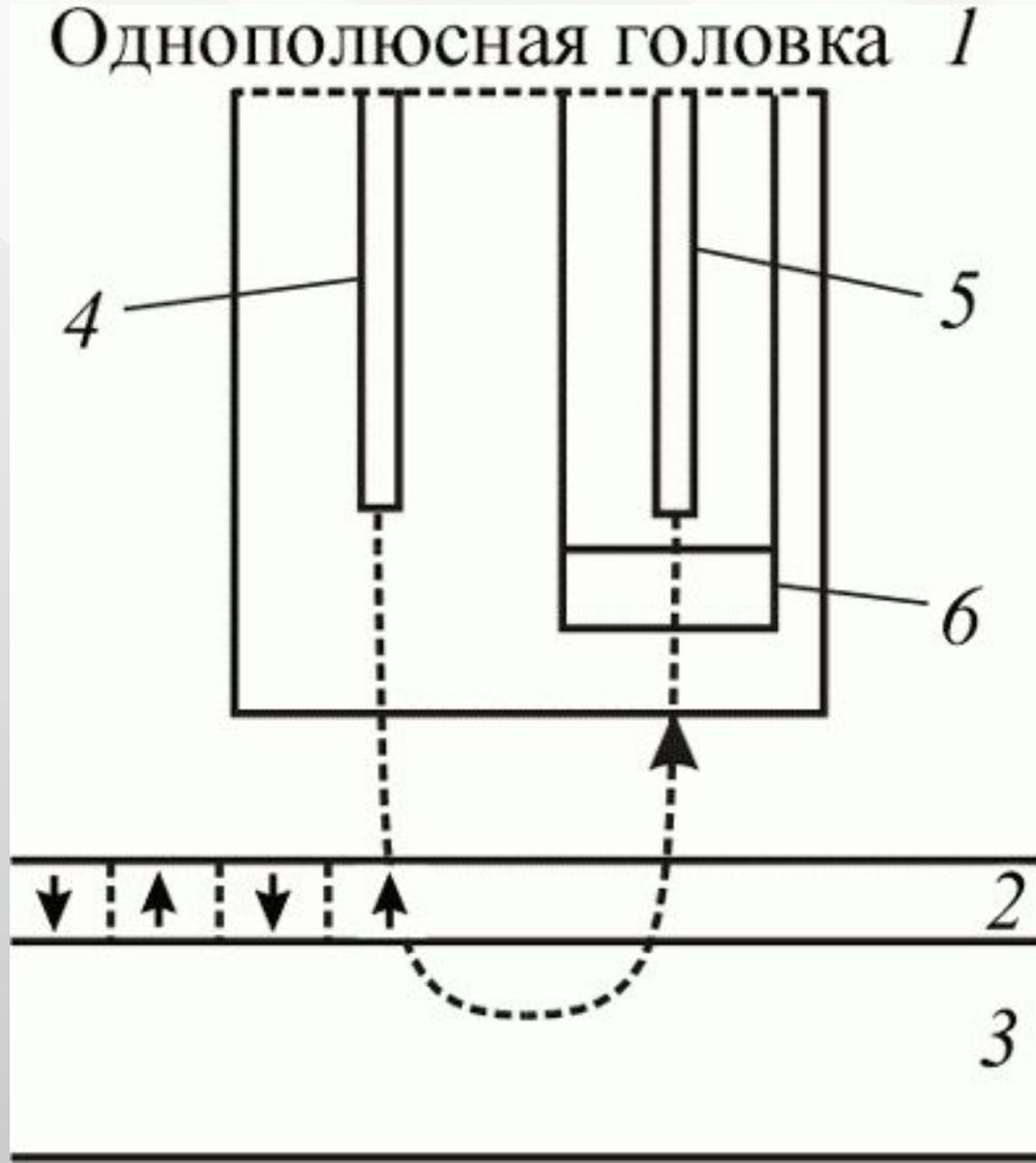
Магнитное вещество нанесено тонким слоем на основу твердого диска.
