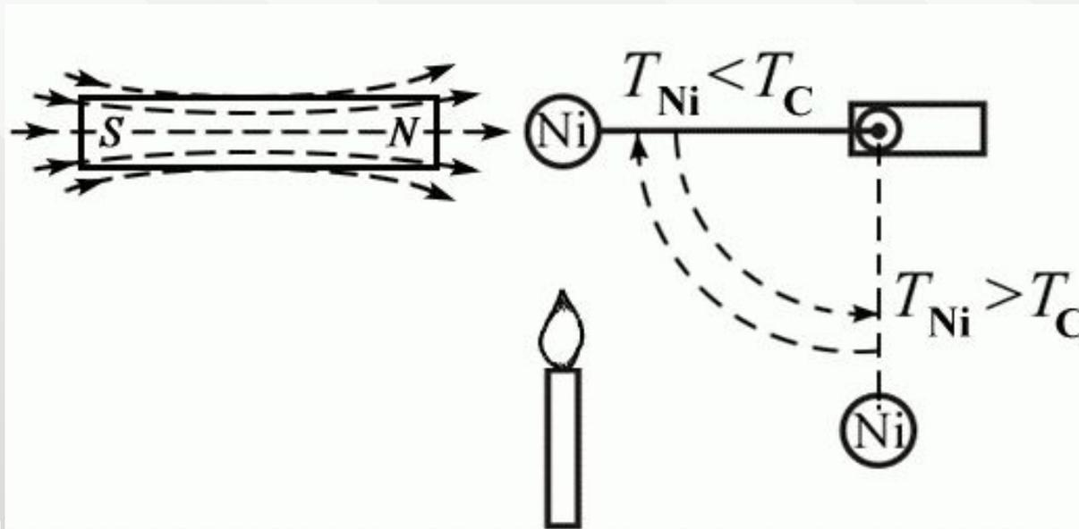
По мере нагрева образца и достижения температуры  $t > T_K$  ферромагнитные свойства у никеля исчезают и образец никеля падает. Остыв до температуры ниже точки Кюри, образец вновь притянется к магниту. Нагревшись, вновь падает и т. д. Эти периодические колебания будут продолжаться все время, пока горит свеча или горелка .
