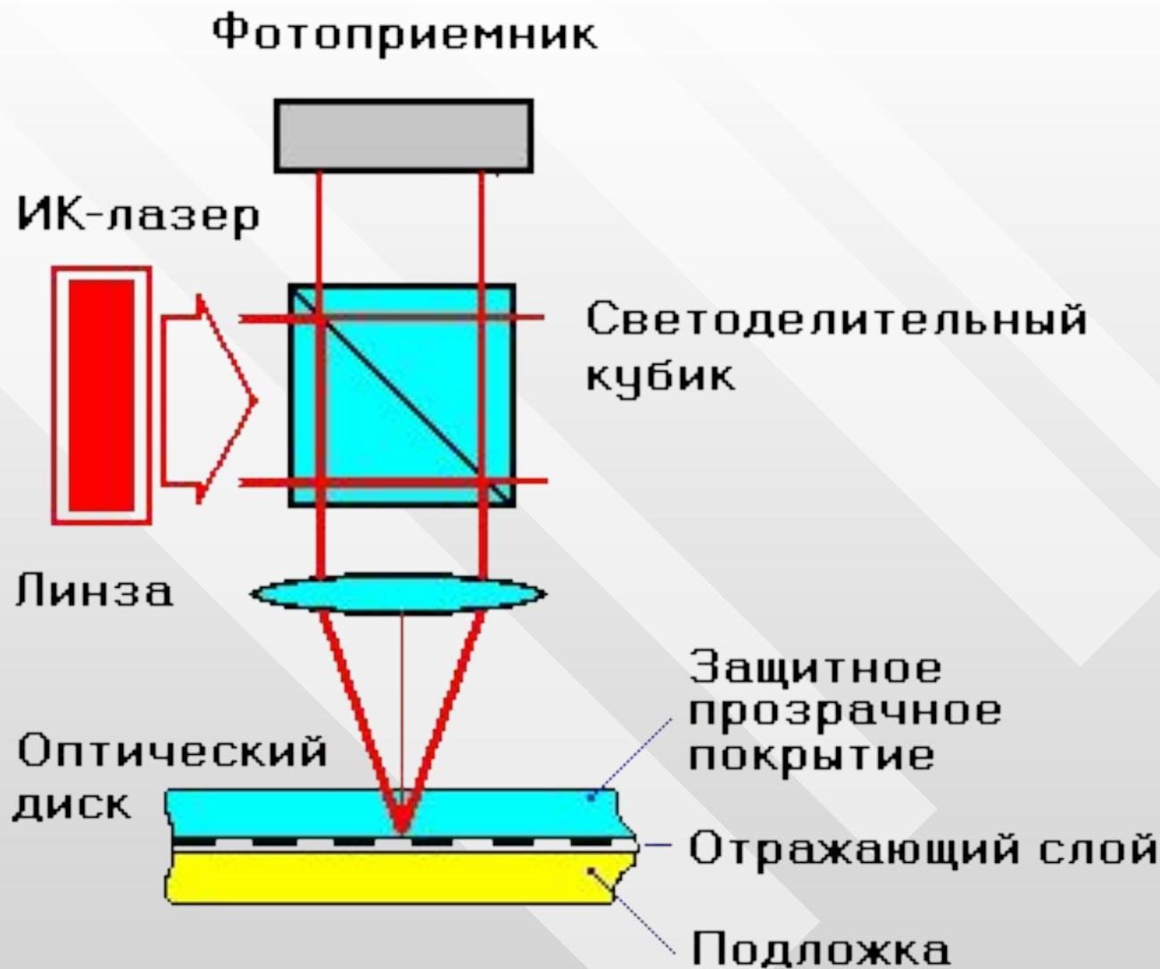
Устройство считывающей головки CD ROM
