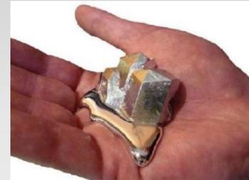
Галлий. Температура плавления  $30^{\circ}\text{C}$
