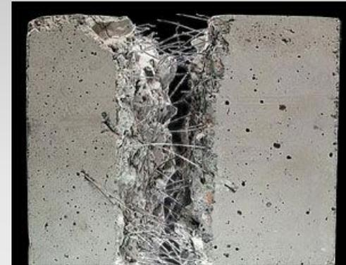
Фибра для бетона
