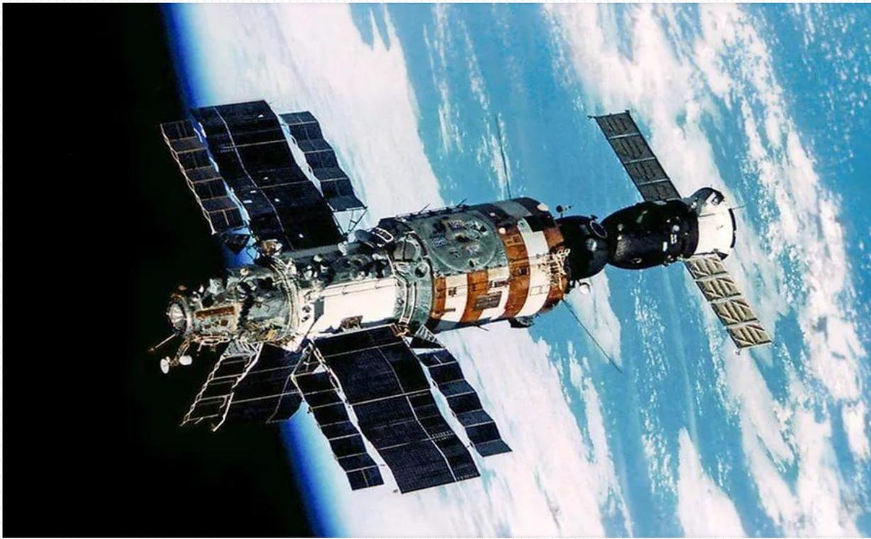
*Первая орбитальная станция «Салют», предназначенная для длительных полетов по орбите вокруг Земли, была запущена 19 апреля 1971 года. Масса полностью заправленной станции составляла 18,9 тонны, длина 16 метров, поперечный размер при раскрытых солнечных батареях 16,5 метров. Станция выводилась на орбиту без экипажа с помощью мощной ракеты-носителя «Протон», хотя могла осуществлять полет в автоматическом режиме и с экипажем на борту.*
