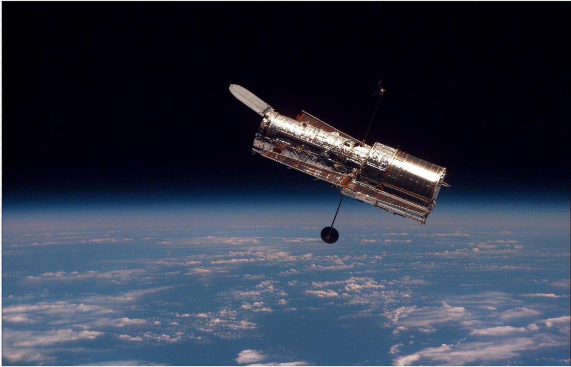
*Космический телескоп Хаббл (Hubble Space Telescope) – околоземный искусственный спутник, оснащенный 2.4-метровым телескопом, работающим в близком ультрафиолетовом, видимом и близком инфракрасном спектре. Телескоп был запущен в 1990 году и работает до сих пор, являясь одним из основных инструментов изучения Вселенной. Назван в честь Эдвина Хаббла.*
