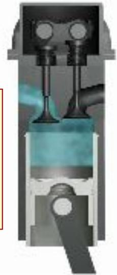
**Рабочим циклом** называется совокупность процессов, которые в определенной последовательности периодически повторяются в цилиндре, в результате чего двигатель непрерывно работает.
