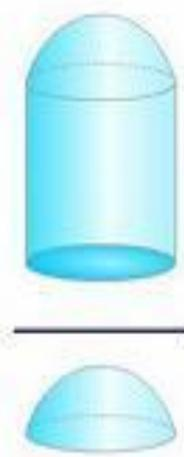
$$\frac{\text{Объем цилиндра}}{\text{Объем камеры сгорания}} = \text{Степень сжатия}$$
